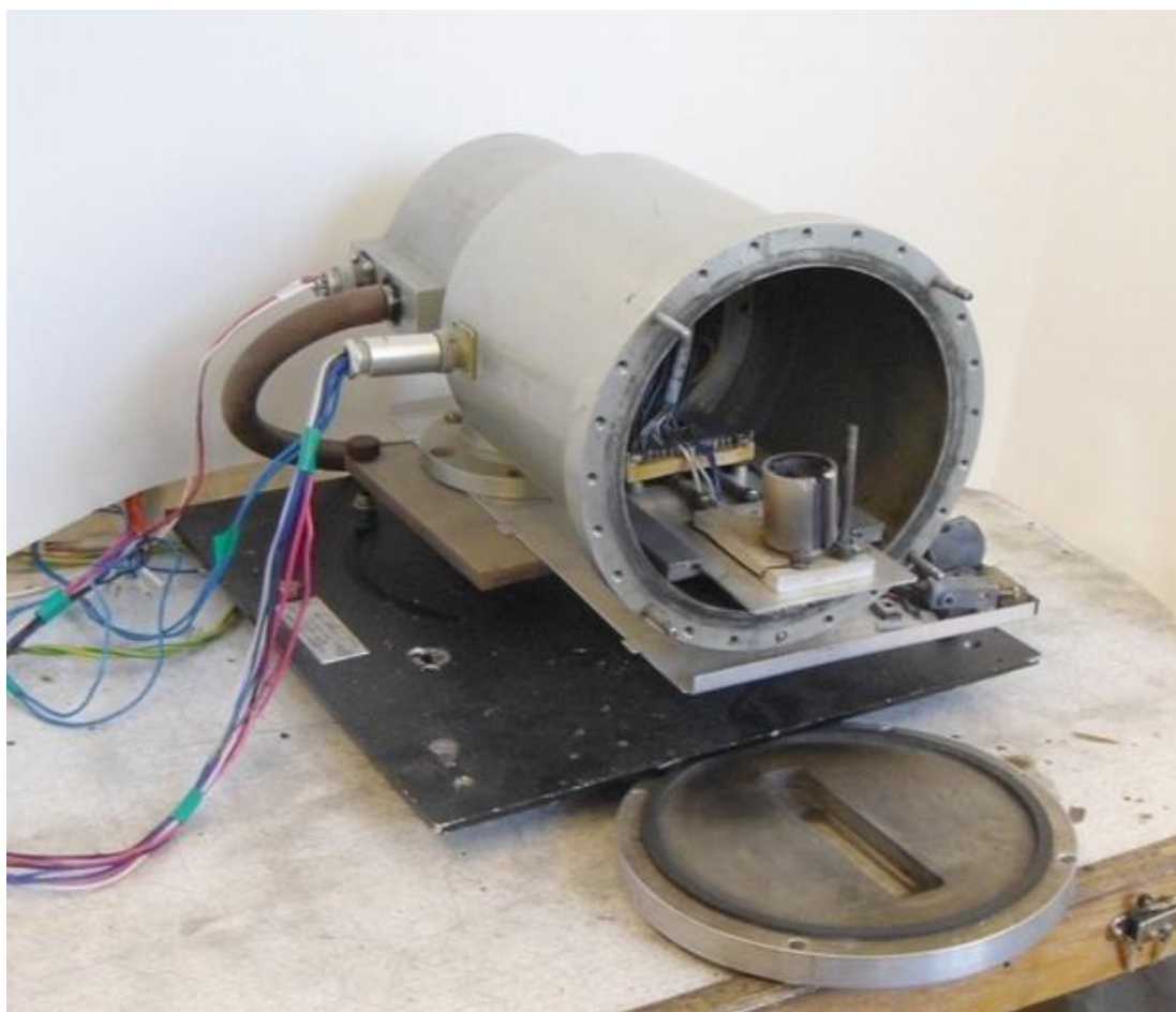
Рисунок 2.1 - Универсальный лабораторный СВС-реактор для проведения экспериментов и термообработки образцов.
