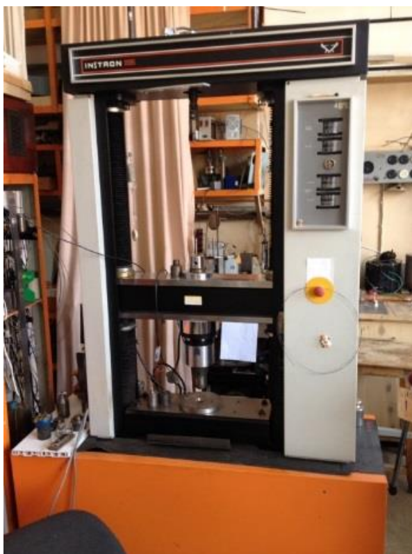
Рисунок 16 – Универсальная испытательная машина «ИНСТРОН»
