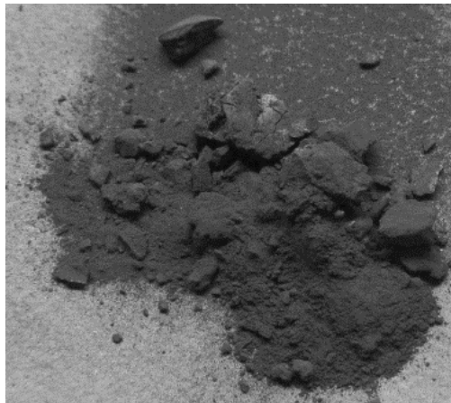
Рисунок 80 – Синтезированный порошок при механическом воздействии t_3 = 10 с, ротор – конус
