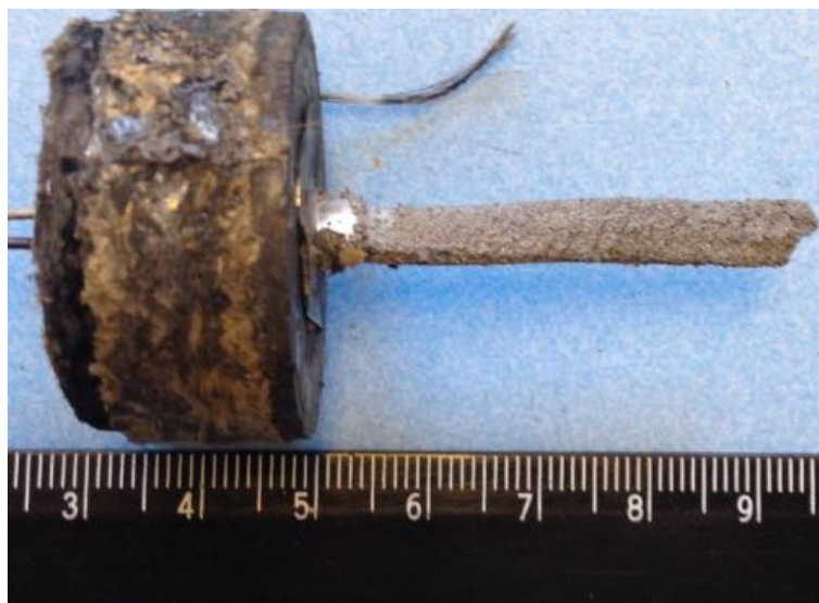
Рисунок 53 – Фотография эффекта «разбухания струи»
