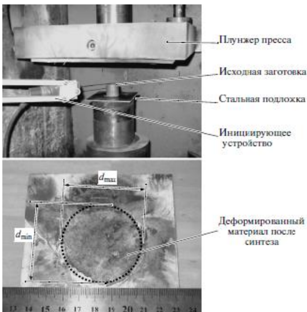
Рисунок 21 – Внешний вид установки и деформированного синтезированного материала
