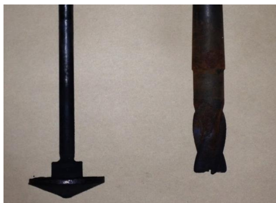
Рисунок 26 – Виды используемых роторов: конус и фреза
