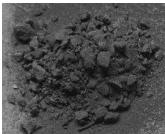
Рисунок 92 – Образец после механический воздействий при t_3 = 10 с, ротор – фреза
