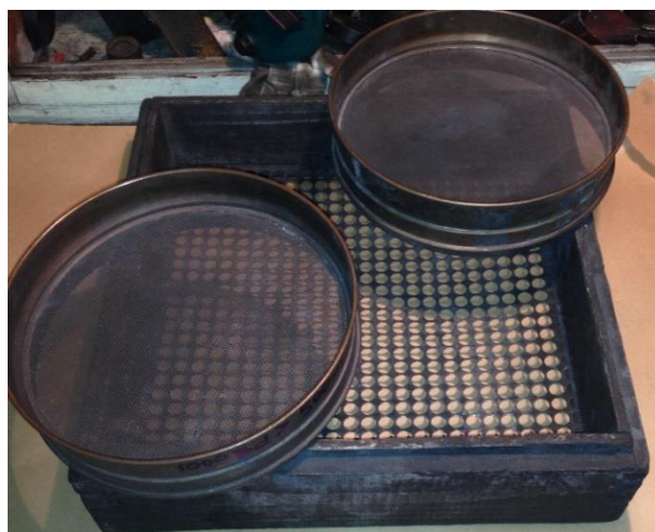
Рисунок 13 – Просеивающие сетки и готовая шихта
