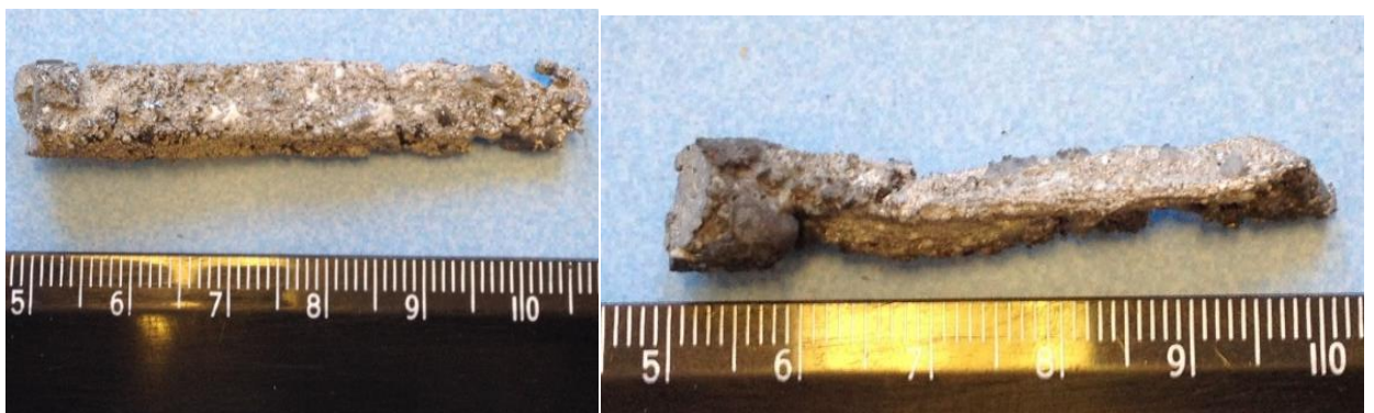
Рисунок 55 – Характерный вид начальной части дефектных образцов
