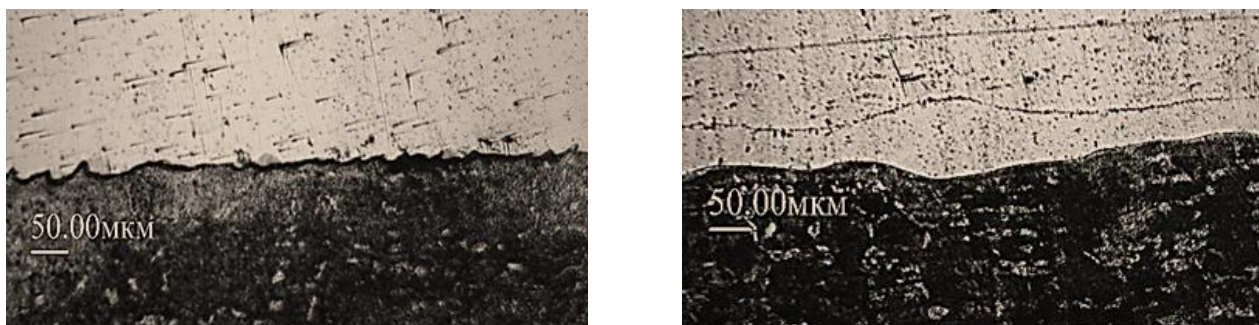
Рисунок 4.15 – Структура границы соединения 37Г2Ф+08Х18Н10Т: а – начальный участок; б – конечный участок
