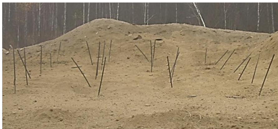
Рисунок 5.16 – Стержни после сварки взрывом на полигоне
