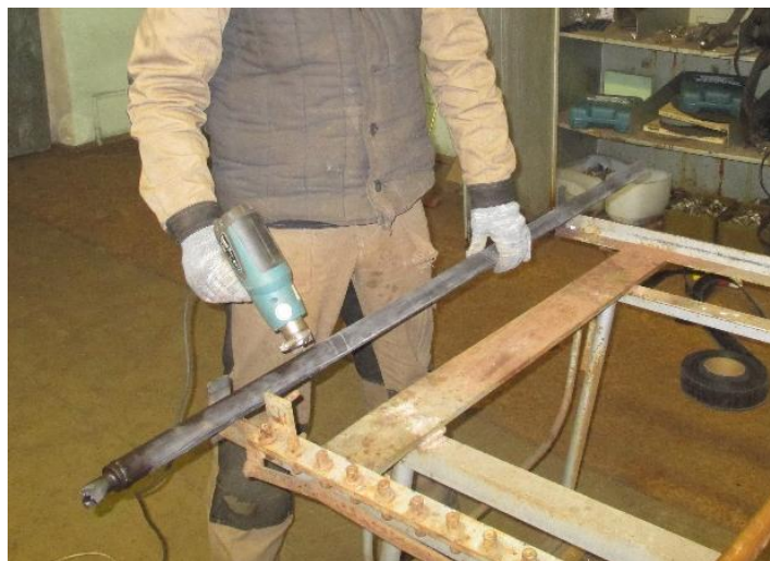
Рисунок 4.19 – Обжatie термоусадочной трубки промышленным феном
