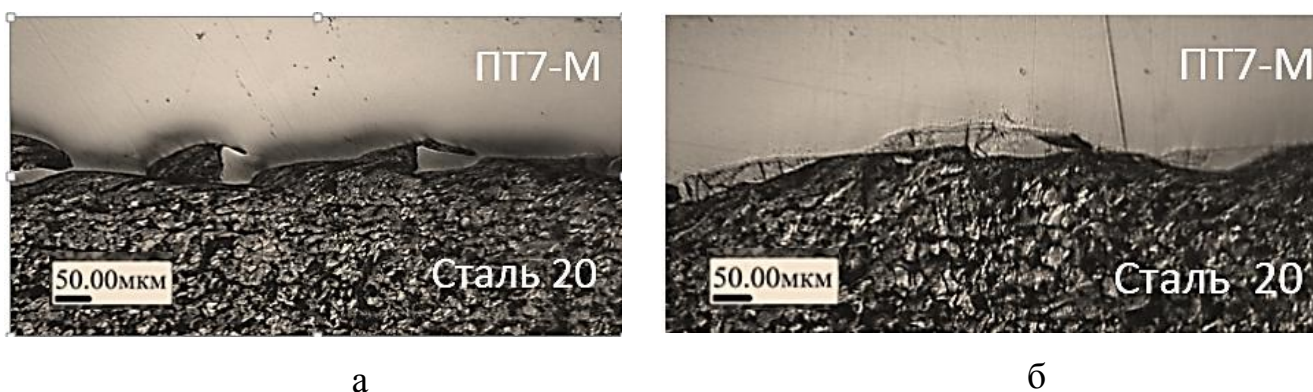
Рисунок 3.22 – Граница соединения сталь+титан, полученная сваркой взрывом (в зазоре аргон): а – начальный участок; б – конечный участок
