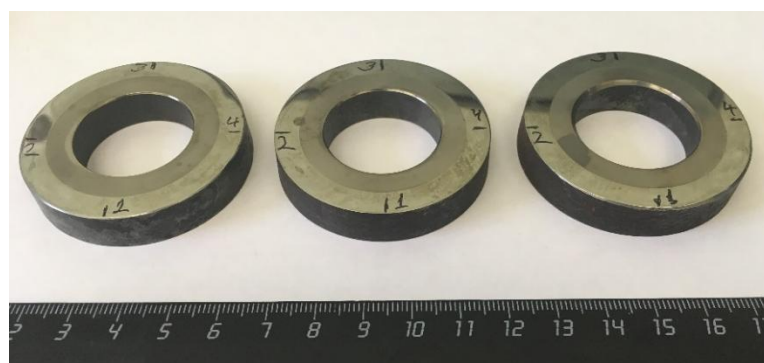
Рисунок 3.18 – Кольцевые биметаллические макрошлифы для исследования микроструктуры в поперечном направлении
