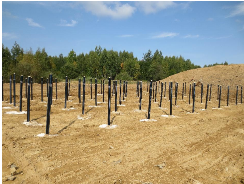
Рисунок 5.15 – Установленные на полигоне перед взрывом заготовки (50 шт.)
