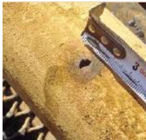
Рисунок 1.4 – Язвенные коррозионные поражения НКТ из стали 32Г2 [77]
