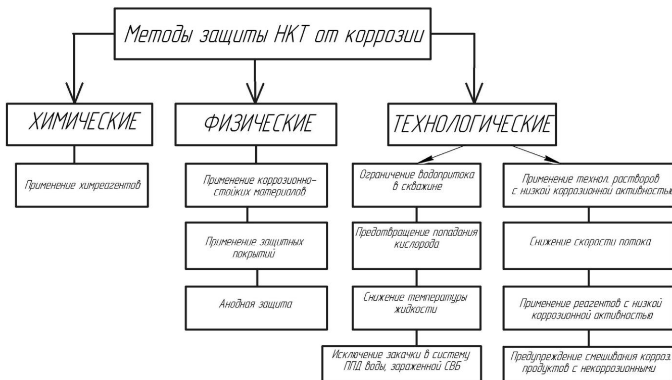
Рисунок 1.5 – Методы защиты НКТ от коррозии [79]
