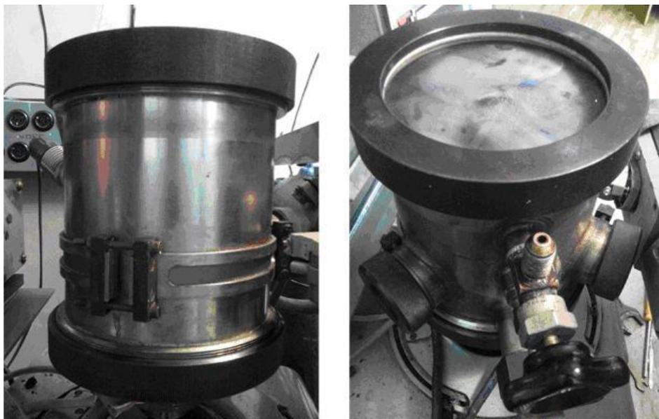
Рисунок 11. Реакционная ячейка установки динамической рентгенографии.
