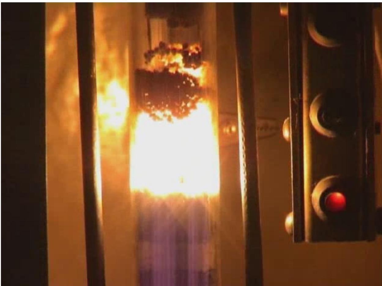
Рисунок 3.11. Фотография процесса горения "влажной" гранулированной шихты (содержание влаги равно 2%) при продуве образца инертным газом
