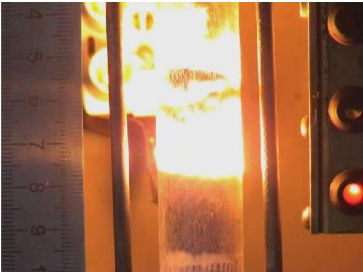
Рисунок 3.6. Фотография процесса горения "сухой" порошковой шихты при продуве образца инертным газом
