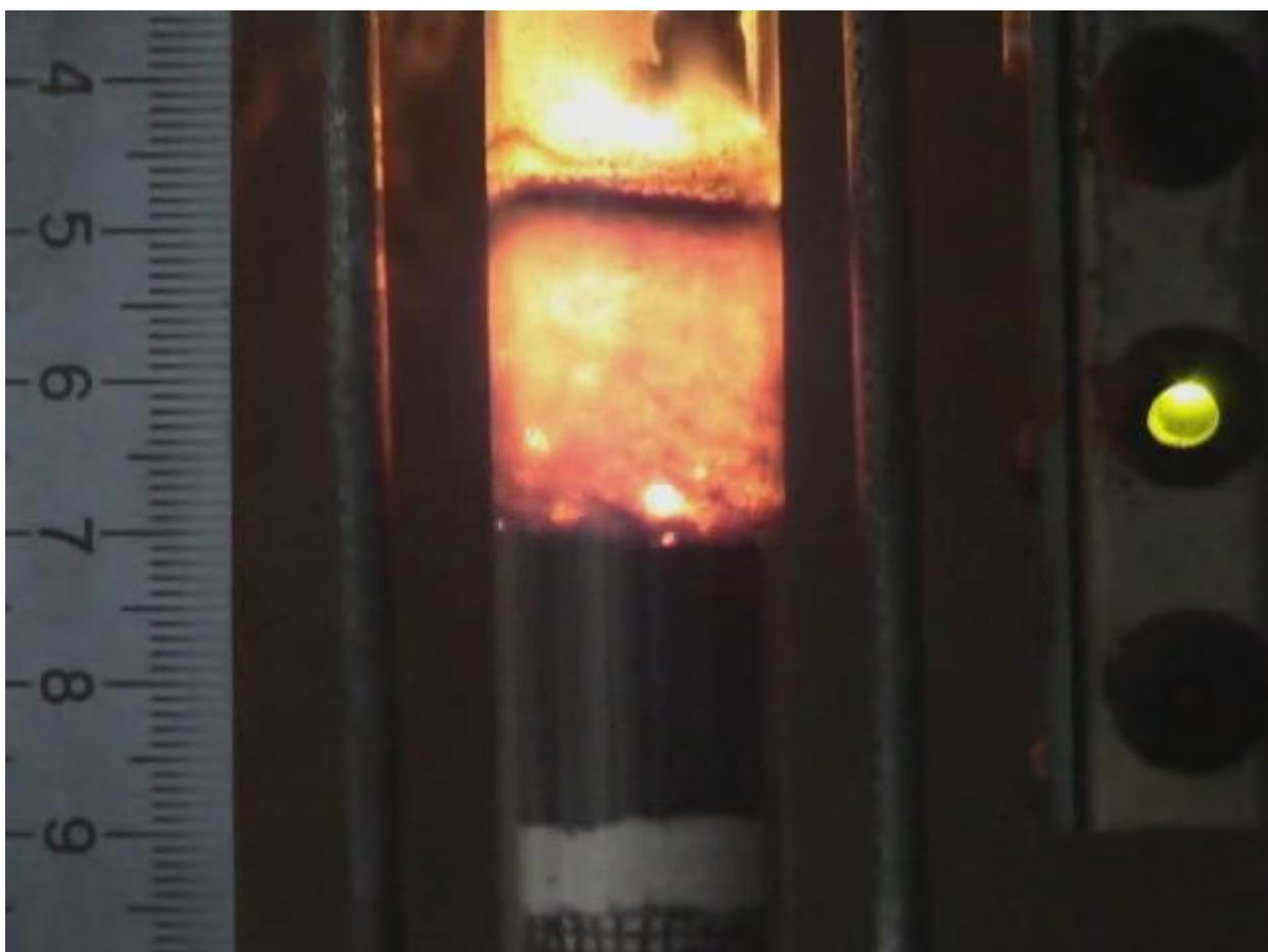
Рисунок 3.4. Фотография процесса горения "сухой" порошковой шихты без продува образца инертным газом
