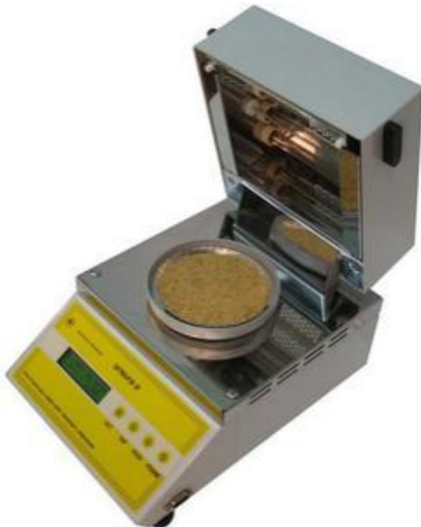
Рисунок 3.3. Анализатор влажности Элвиз 2С
