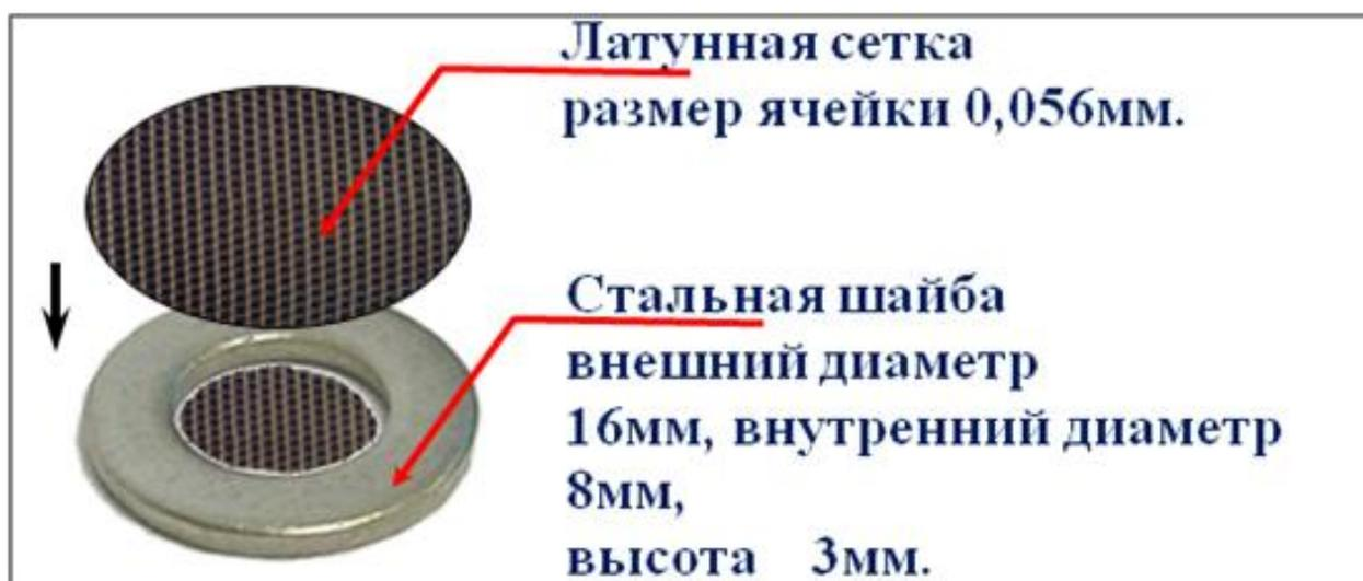
Рисунок 4.2. Схема узла разделяющего на две части гранулированную засыпку
