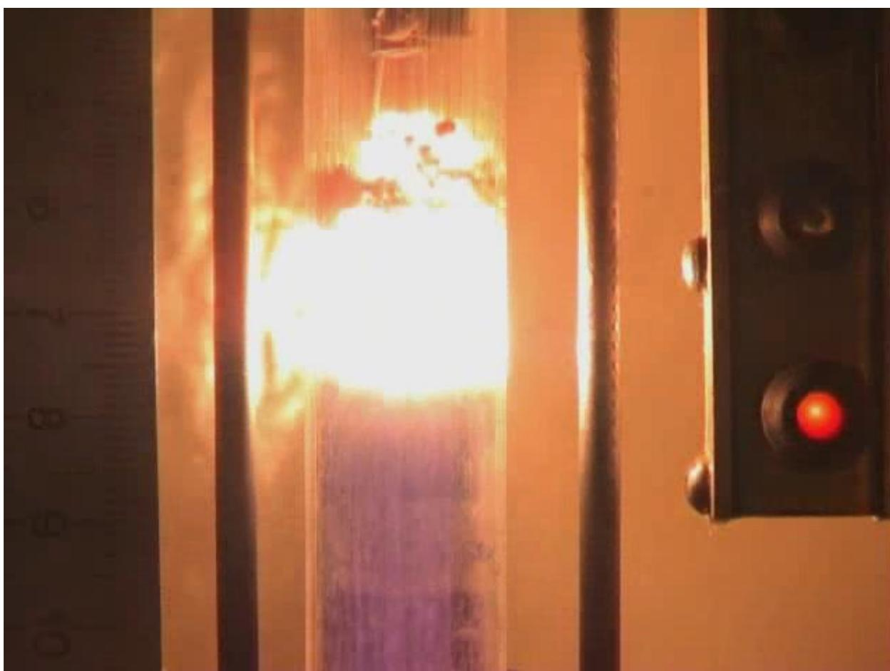
Рисунок 3.10. Фотография процесса горения "сухой" гранулированной шихты при продуве образца инертным газом
