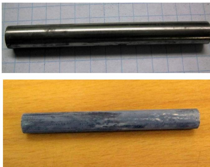
Рисунок 73 – Фото образцов состава 3Ti-2,3Al-2C до и после испытаний
