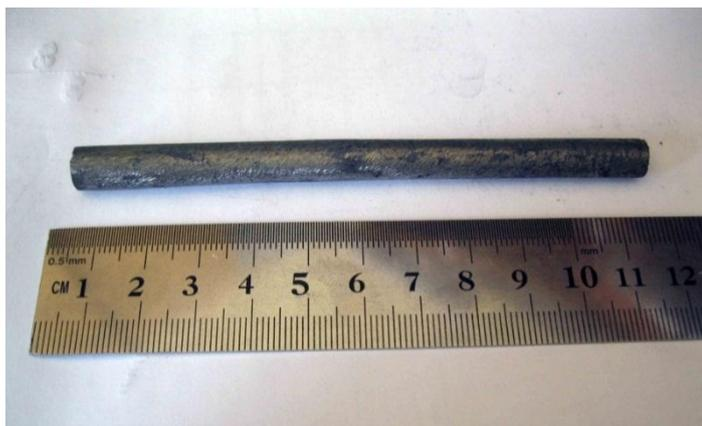
Рисунок 49 – Общий вид экструдированного образца состава 3Ti-1Al-2C, d=10 мм
