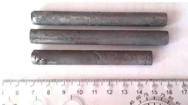
Рисунок 48 – СВС-электроды состава  $2\text{Ti}-1,5\text{Al}-1\text{C}$
