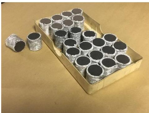
Рисунок 16 – Спрессованные шихтовые заготовки
