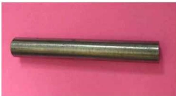
Рисунок 71 – Фото образца 3Ti-2,3Al-2C до испытаний
