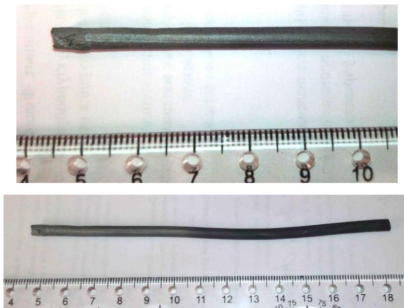
Рисунок 40 – Фото экструдированных образцов состава  $2\text{Ti}-1,5\text{Al}-1\text{C}$  с высотой матрицы  $h = 15$  мм, углом  $180^\circ$ , в отсутствие внешнего подогрева
