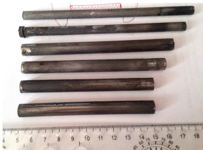
Рисунок 50 – Общий вид экструдированных образцов различных составов
