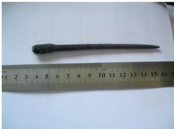
Рисунок 38 – Экструдированный образец с высотой матрицы  $h = 20$  мм, углом  $120^\circ$ , в отсутствие внешнего подогрева
