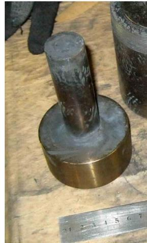
Рисунок 42 – Схема и общий вид модернизированного штока
