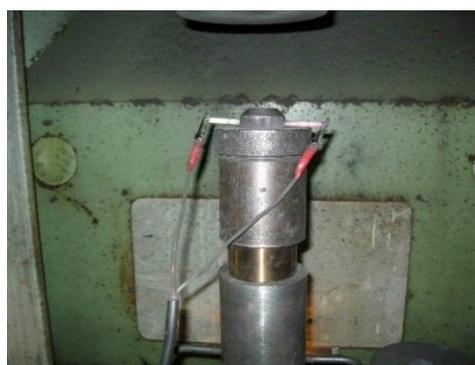
Рисунок 19 – Пресс-форма для СВС-экструзии
