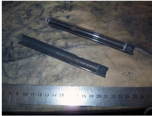
Рисунок 44 – Направляющий калибр, кварцевая трубка
