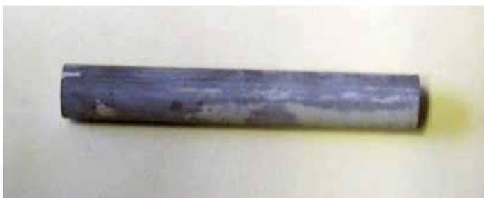
Рисунок 72 – Фото образца 3Ti-2,3Al-2C после испытаний
