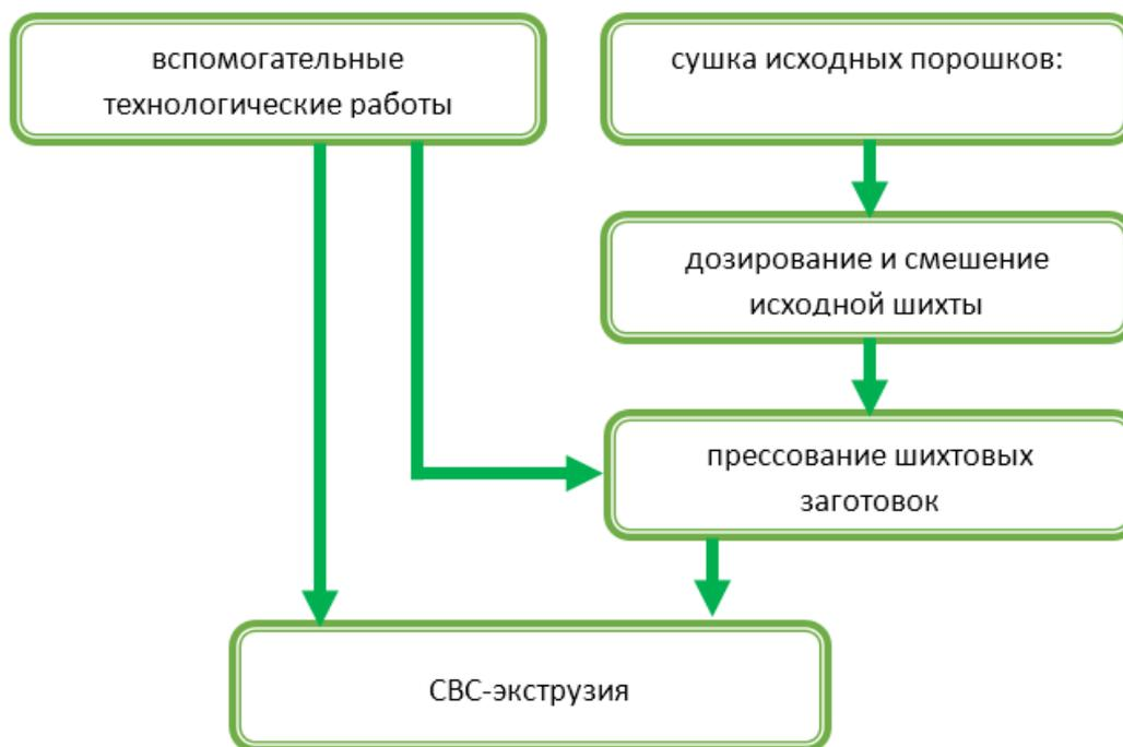
Рисунок 12 – Технологическая схема СВС-экструзии
