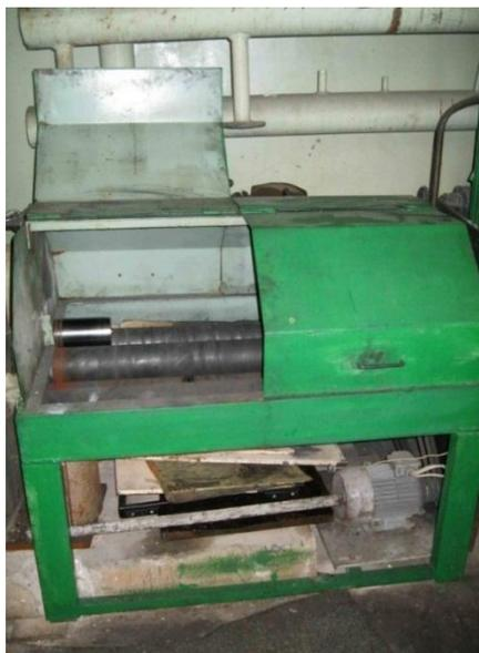
Рисунок 13 – Установка для шаровых мельниц
