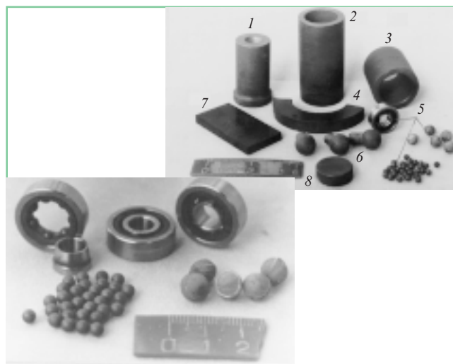
Рис. 5. Детали двигателя из «черной керамики»: 1 – толкатели; 2 – втулки толкателей; 3 – втулки промежуточной шестерни; 4, 8 – пары трения; 5 – шарикоподшипники; 6 – наконечники штанги толкателя; 7 – износостойкие пластины
