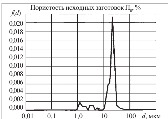
Рис. 3. Дифференциальная функция распределения величины пор по образцу керамического фильтроэлемента с однородной структурой из TiC (средний размер пор, мкм; по объему - 16,73, по поверхности - 15,4; усредненный размер пор ( 4V/A ), мкм - 16,2)
