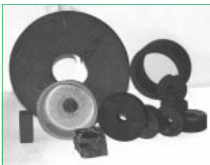
Рис. 8. Слёк литьевого СВС-розового корунда и шлифовальный инструмент из него (круги, бруски, кольца)
