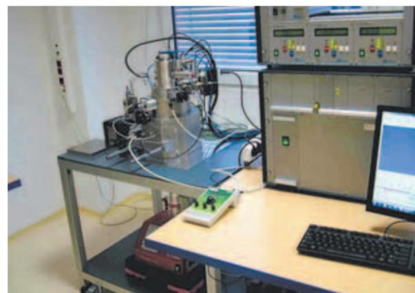
Низковольтная электронно-зондовая система для мониторинга дефектов
