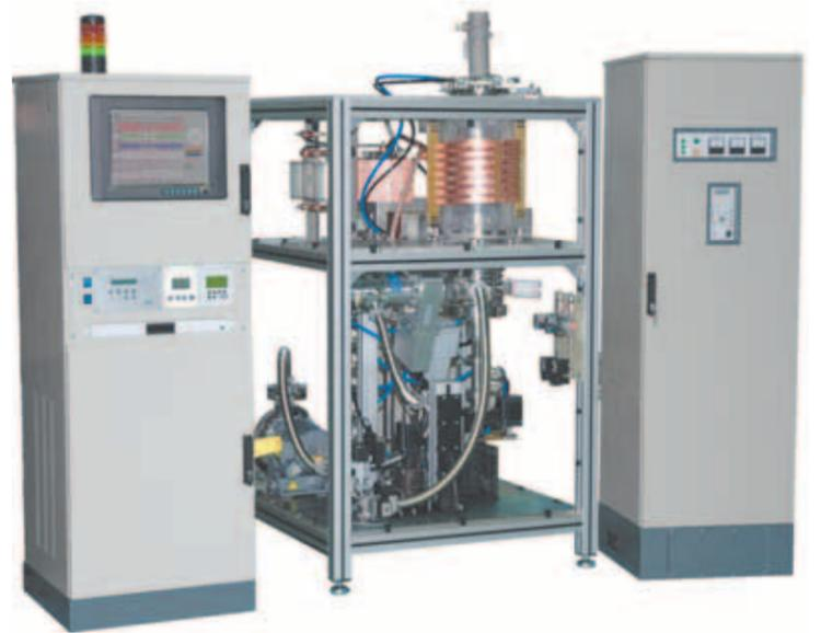
Установка для выращивания монокристаллов карбида кремния сублимационным методом
