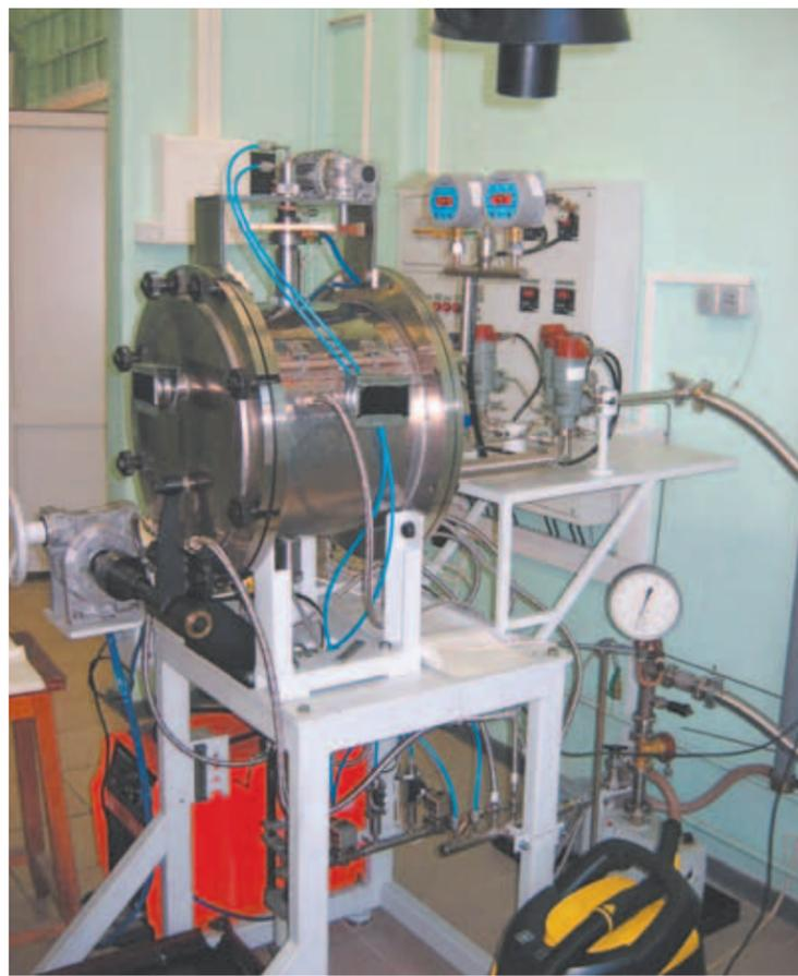
Автоматизированная установка электродугового синтеза научно-производственного комплекса ИПХФ РАН "Углерод-Чг"
