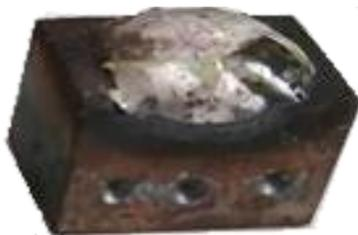
Рисунок 51 – Внешний вид покрытий, наплавленных промышленными электродами Т-620
