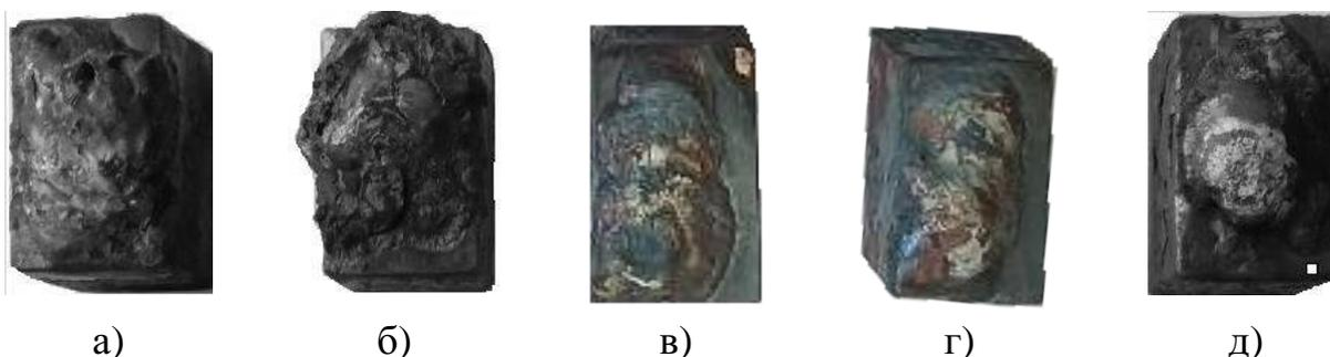
Рисунок 47 – Внешний вид покрытий, наплавленных СВС-электродами Ti+1,7V+0,6Fe при силе тока 50 А (а), 60 А (б), 70 А – режим №3 (в), 80 А – режим №4 (г) и 90 А (д)
