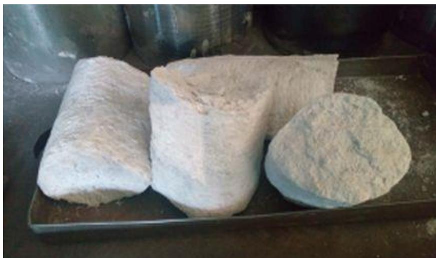
Рисунок 122 – Спе́к композиции  $\text{Si}_3\text{N}_4\text{-MgO}$ , полученный из шихты с содержанием кремния 23 %масс
