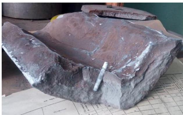
Рисунок 141 – Чехол термопары из керамики нитрида бора в спёке азотированного сплава ВнАл-1
