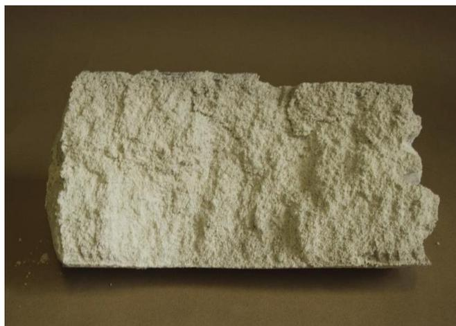
Рисунок 92 – Структура спека полученная при горении шихты содержащей 21 %масс. кремния с  $S_{уд.}=12 \text{ м}^2/\text{г}$
