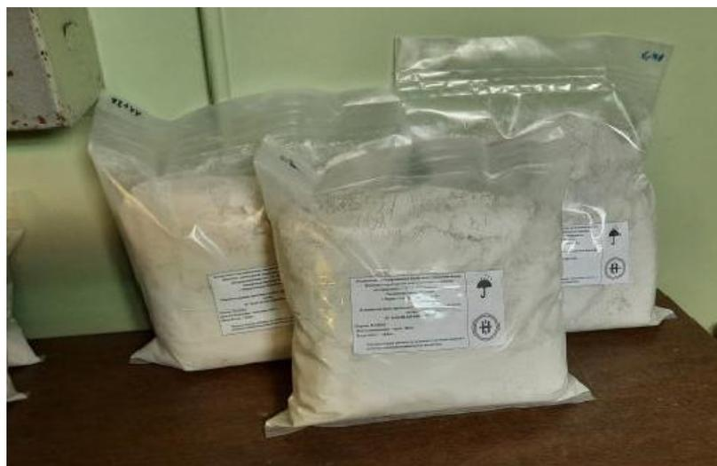
Рисунок 112 – Упаковки порошков нитрида кремния с равноосной формой частиц
