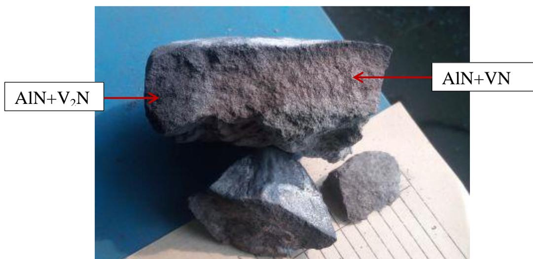
Рисунок 140 – Участок спёка после остановки горения
