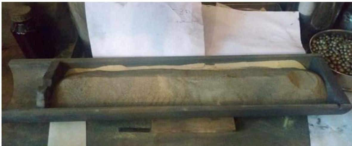
Рисунок 151 – Реакционная шихта в лодочке
