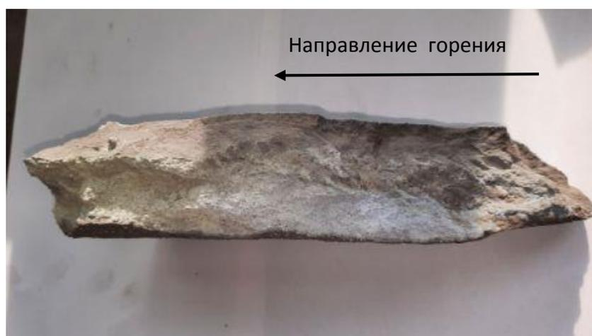
Рисунок 142 – Продольный излом спёка. Переход от послойного горения к поверхностному
