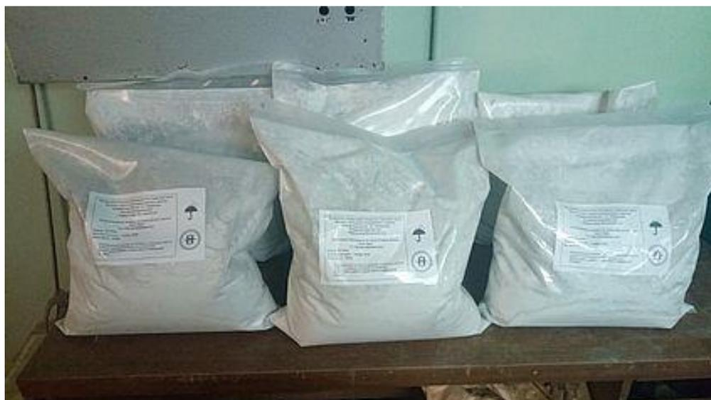
Рисунок 130 – Упаковки с композиционным порошком  $\alpha\text{-Si}_3\text{N}_4\cdot\text{MgO}$
