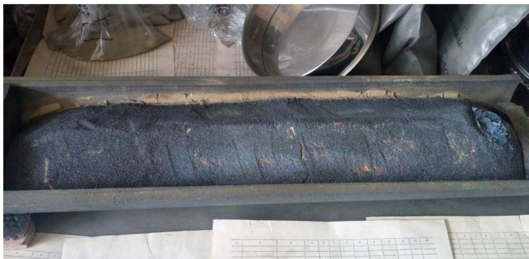
Рисунок 157 – Налет на поверхности спека нитрида циркония
