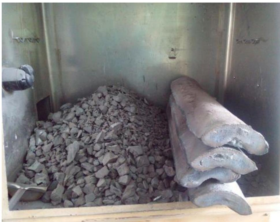
Рисунок 146 – Спёки и куски азотсодержащего материала состава V-Al-N
