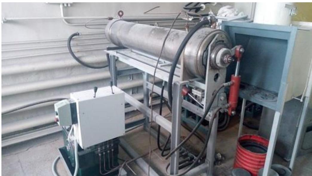
Рисунок 150 – Реактор СВС-30
