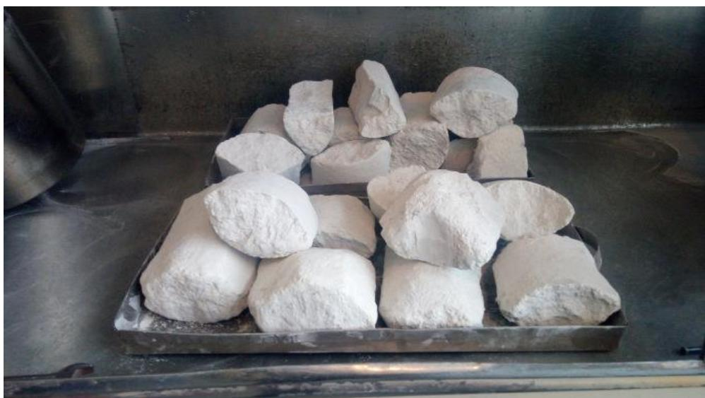
Рисунок 111 – Спёки нитрида кремния с равноосной формой частиц
