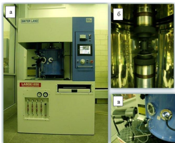
Рисунок 7 – Установка искрового плазменного спекания «Labox 650»: (а) – внешний вид, (б) – рабочая камера, (в) – пирометр
