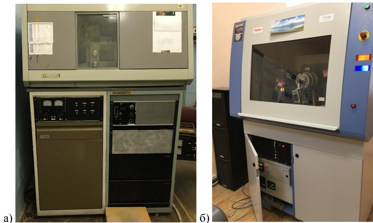
Рисунок 15 – Фотографии дифрактометров: (а) – ДРОН-3М, (б) – ARL`XTRA
