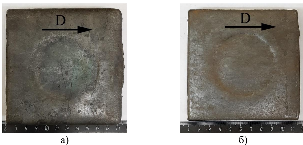
Рисунок 48 – Внешний вид стальных матриц после ударно-волнового нагружения: а) при скорости метания 1,5 км/с, б) 0,5 км/с
