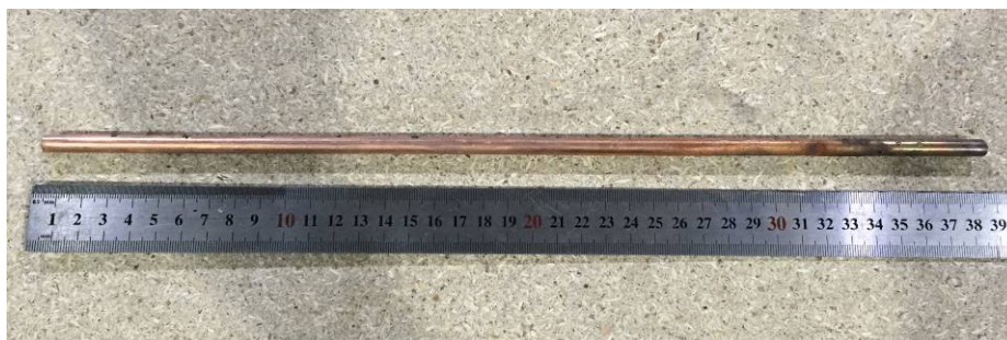
Рисунок 33 – Внешний вид длинномерного стержня из сплава \text{Cu}_{70}\text{Fe}_{30} полученного из переплавленного СВС-заготовки.
