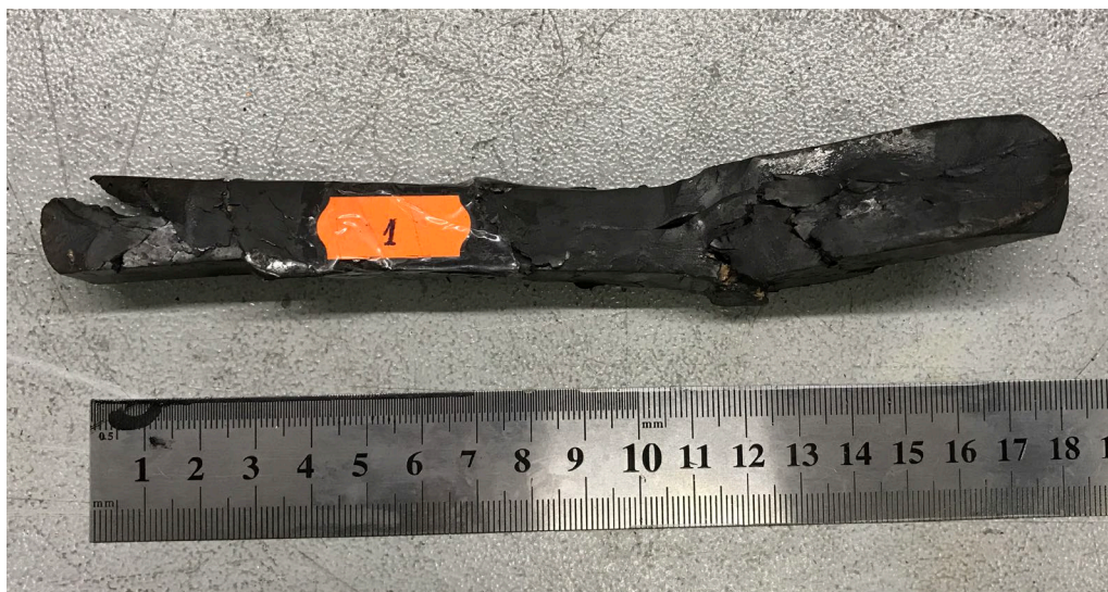
Рисунок 27 – Развалившийся образец СВС-сплава послековки.
