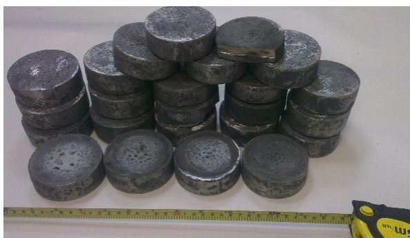
Рисунок 40 – Внешний вид синтезированных СВС-слитков сплава ХТН-61 (СВС-Ц) для исследований при ВИП.
