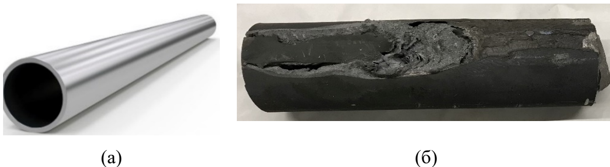
Рисунок 73 – Внешний вид: (а) трубчатой оболочки – кристаллизатора ( \delta = 3\text{ мм} ) до разливки и после разливки; (б) с размытой и оплавленной частью оболочки.
