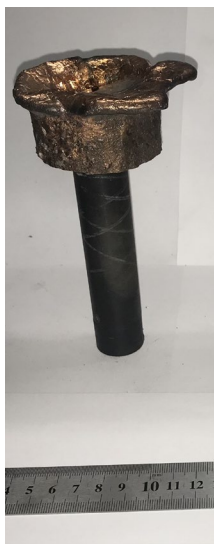
Рисунок 28 – Внешний вид образца \text{Cu-Fe} сплава, полученного методом ВИ-плавления.
