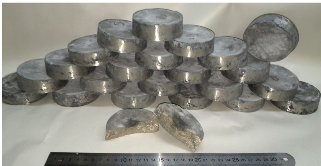
Рисунок 63 – Внешний вид партии полученных образцов (слитки СВС сплава CompoNiAl) после модернизации крепежной оснастки на роторе центробежной СВС которая позволила увеличить массу получаемых слитков с 0,7 кг до 1 кг.
