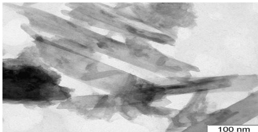
Рисунок 12 – Снимок кристалла состава K_xMoO_3 в разрешении 100 нм
