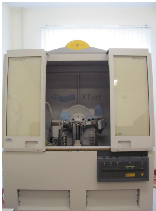
Рисунок 9 – Дифрактометр X'Pert Pro (Philips, Netherland)
