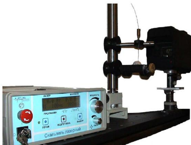
Рисунок 36 – Установка для измерения температуры хряща в точке облучения
