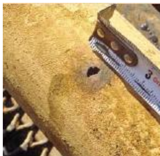
Рисунок 1.4 – Язвенные коррозионные поражения НКТ из стали 32Г2 [77]
