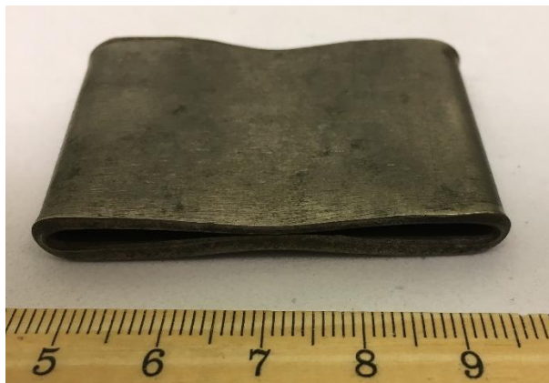
Рисунок 5.12 – Образец из титановой трубы ВТ1-0 после испытания на сплющивание до полного соприкосновения сторон
