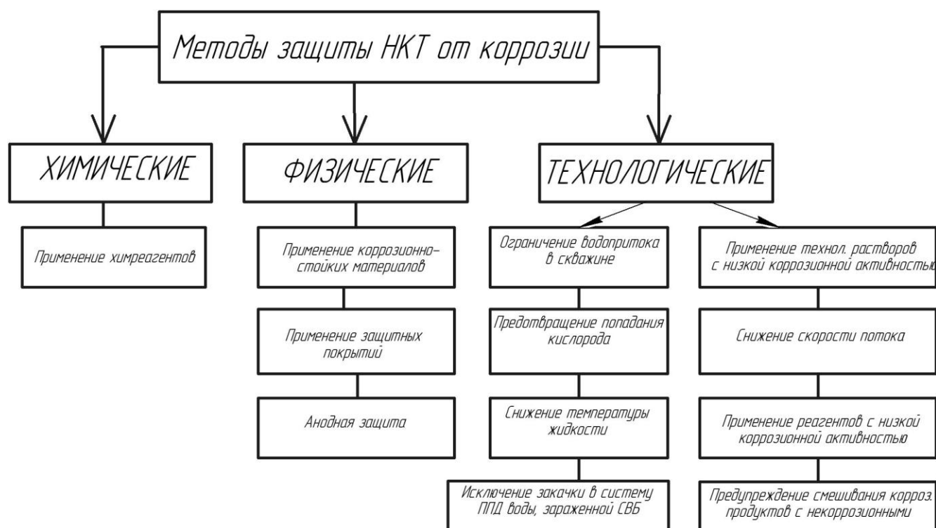
Рисунок 1.5 – Методы защиты НКТ от коррозии [79]
