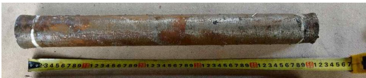
Рисунок 3.16 – Внешний вид заготовки после сварки взрывом (белым отмечена зона несплошности в начале и конце заготовки).
