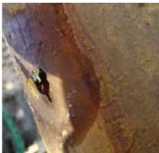
Рисунок 1.4 – Язвенные коррозионные поражения НКТ из стали 32Г2 [77]
