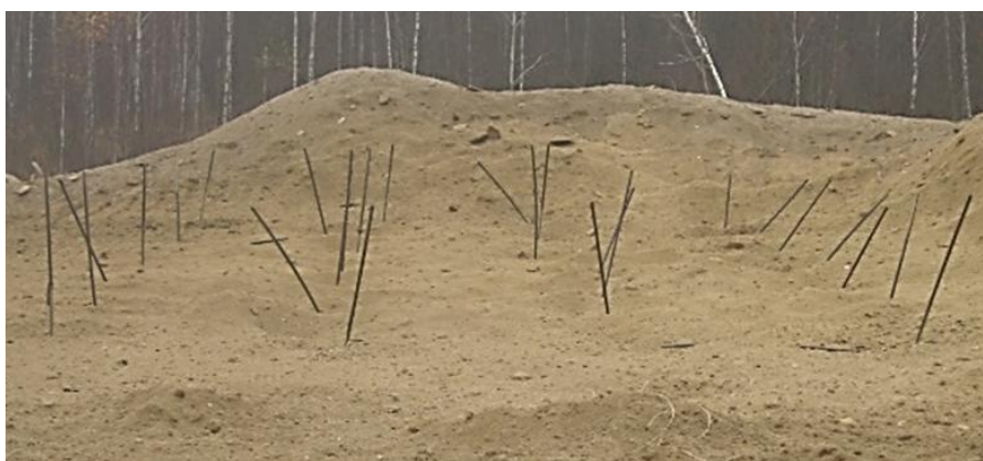
Рисунок 5.16 – Стержни после сварки взрывом на полигоне
