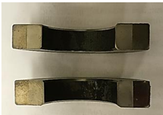
Рисунок 3.19 – Микрошлифы для исследования структуры соединения в биметаллической трубе сталь 20+ титан ПТ-7М в продольном направлении
