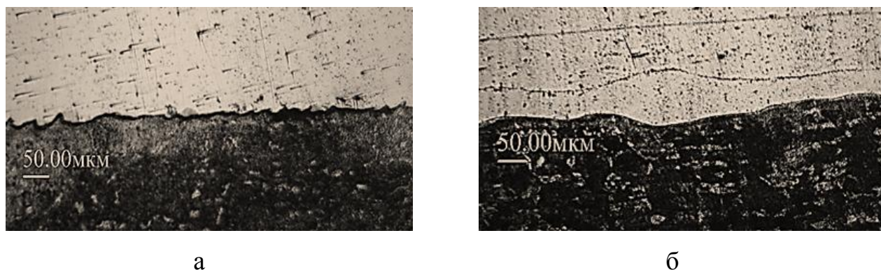
Рисунок 4.15 – Структура границы соединения 37Г2Ф+08Х18Н10Т: а – начальный участок; б – конечный участок
