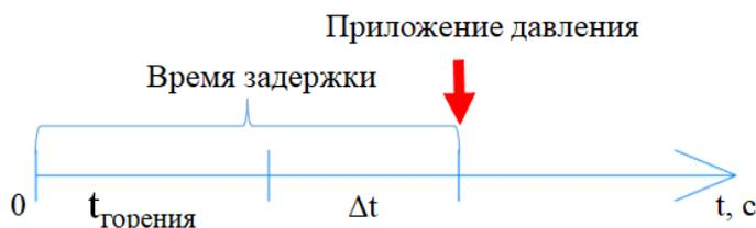
Рисунок 16 – Определение времени задержки
