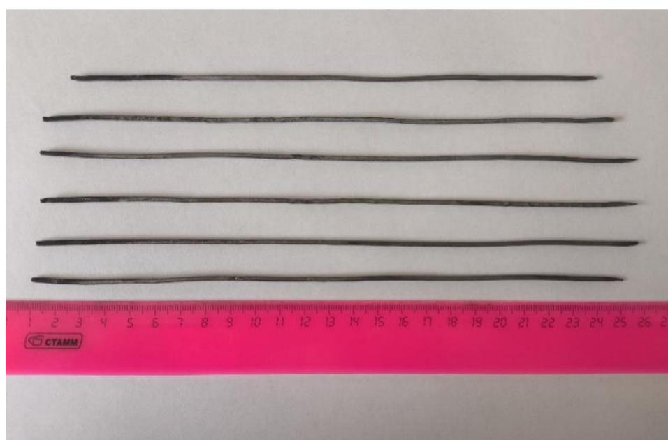
Рисунок 33 – Фото экструдированных стержней
