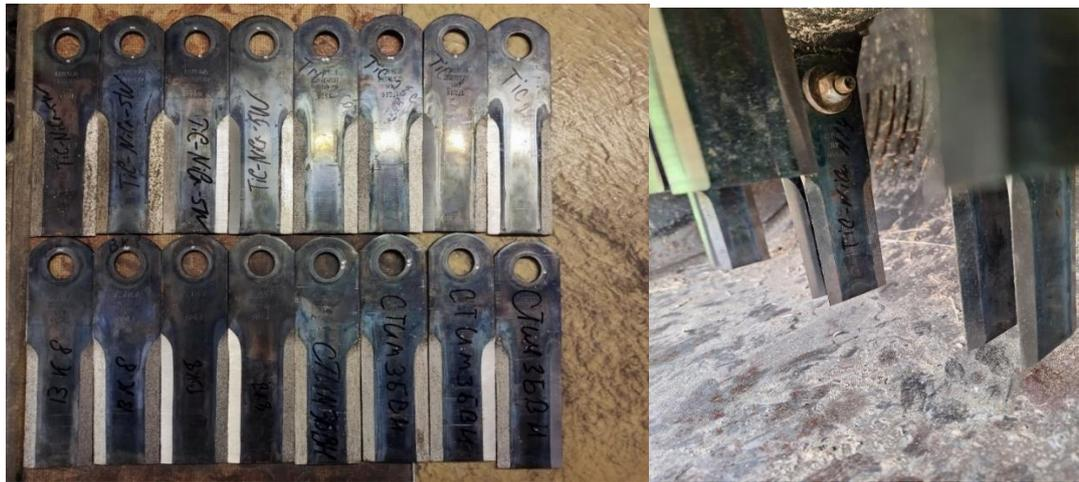
Рисунок 80 – Ножи соломоизмельчителя с защитными покрытиями на основе  $\text{TiC-30NiCr}$  и  $\text{TiC-30NiCr - (5,10)W}$
