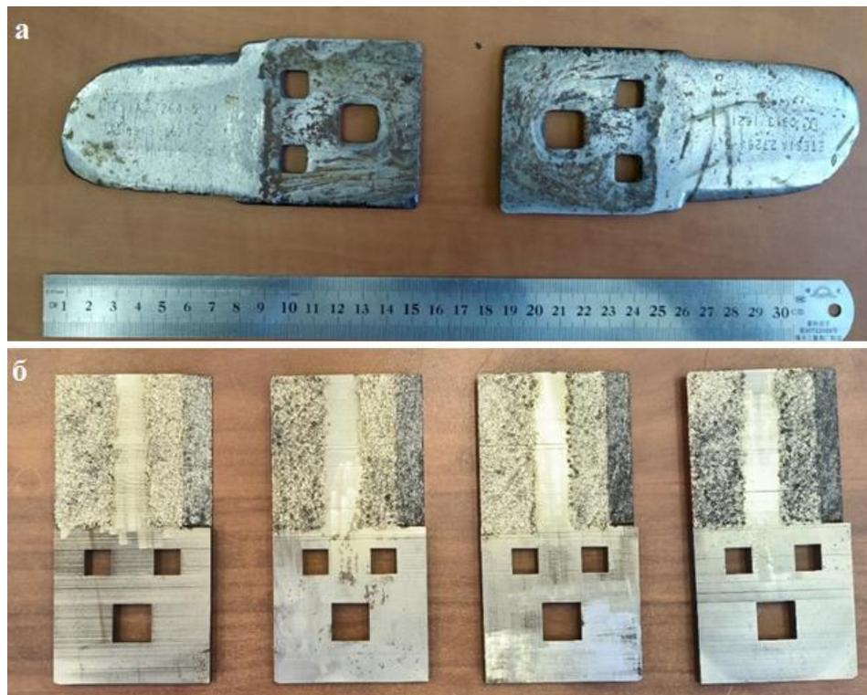
Рисунок 81 – Фото ножей: а - после отработки, б- ножи с нанесенными защитными покрытиями
