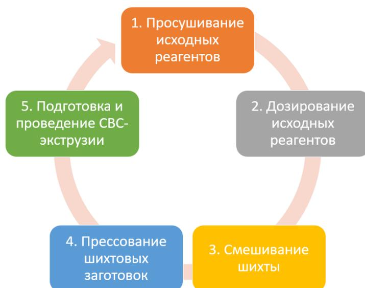
Рисунок 17 – Технологический процесс СВС-экструзии
