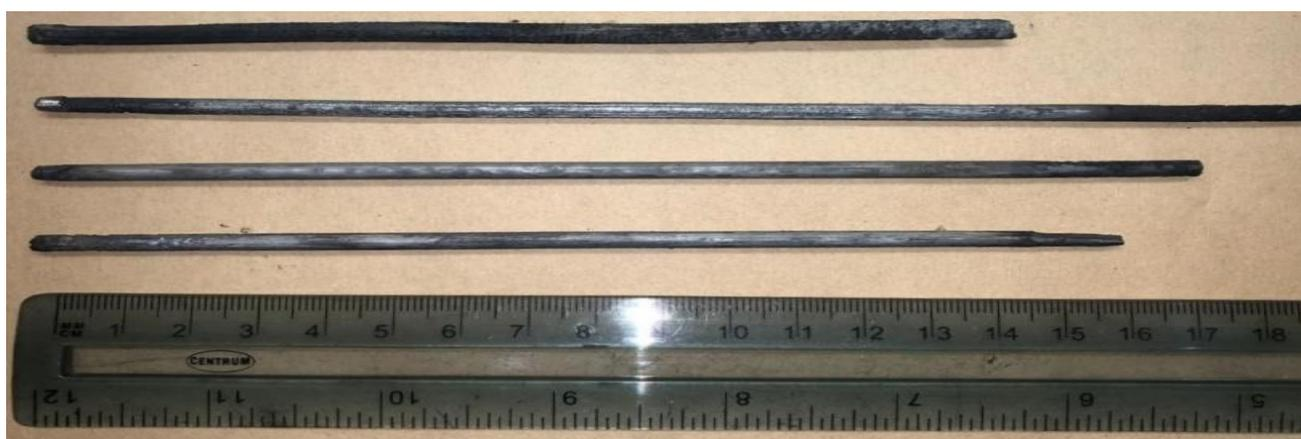
Рисунок 55 – Фото экструдированных стержней на основе Ti-C-NiCr-W
