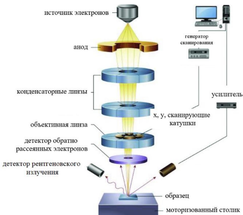
Рисунок 21 – Схема СЭМ
