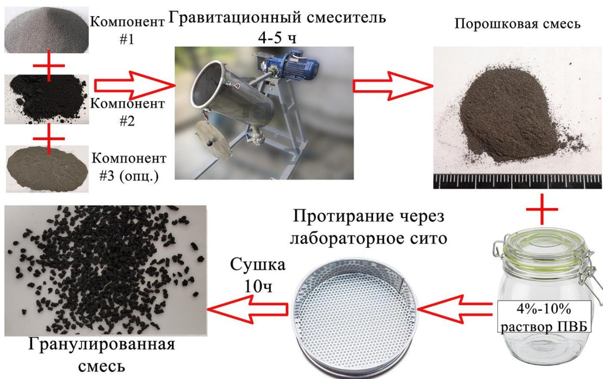
Рисунок 2.5 – Схематическое изображение стадий гранулирования
