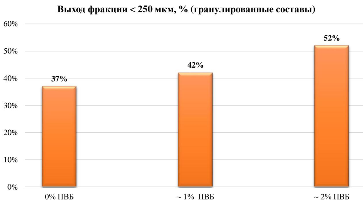
Рисунок 4.12 – Размол продуктов синтеза (Ti+C)+Ni 20% (масс.)
