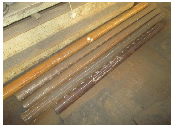
Двухслойные трубные заготовки длиной 1000 мм Двухслойные трубные заготовки длиной 2500 мм
