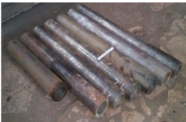
Двухслойные трубные заготовки длиной 1000 мм Двухслойные трубные заготовки длиной 2500 мм
