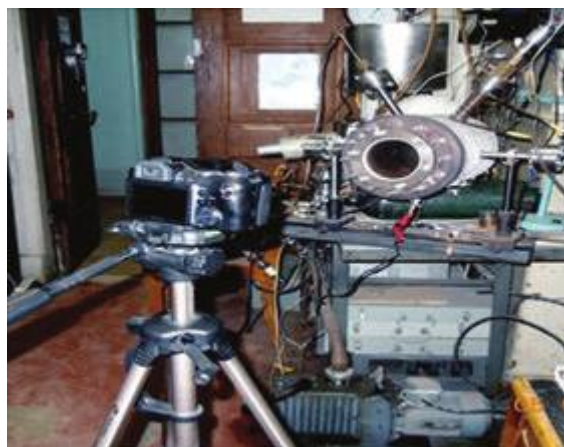
Рис. 1.2. Расположение скоростной видеокамеры для съемки процесса горения
