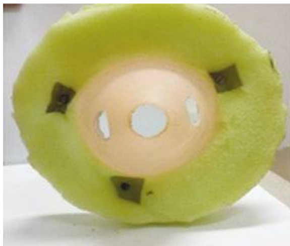
Рис. 2.4. Препятствие конической формы с тремя отверстиями (угол раскрытия 83^\circ )
