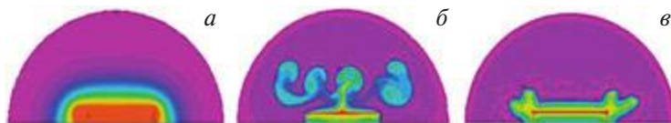
Рис. 1.2. Расчет методом конечных элементов [16] (см. Приложение) распространения зоны горения в приближении Буссинеска a - g = 0 , b - g = 980 \text{ см/с}^2 , v - расчет распространения зоны горения при g = 0 , решение уравнений Навье – Стокса для сжимаемой среды, \zeta = 16
