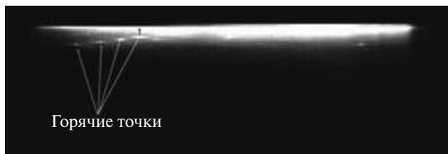
Рис. 1.14. RGB гиперспектрального изображения горения смеси 40% H_2 – воздух, инициированного платиновой проволокой, полученный при использовании модифицированного гиперспектрометра ВИД-ИКЗ, T_0 = 320^\circ C , P_0 = 1 атм, спектральный интервал 550–650 нм
