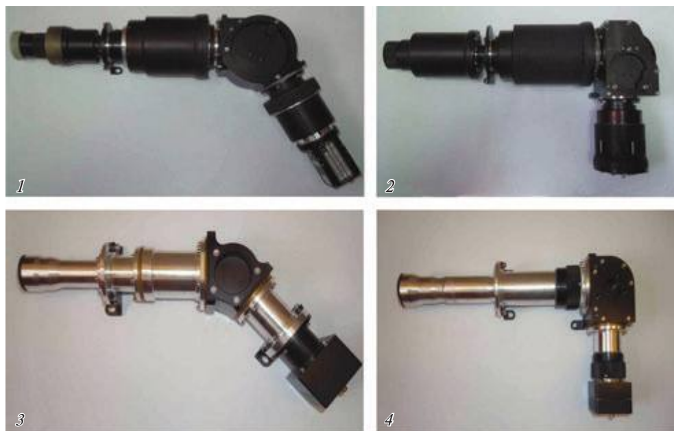
Рис. 13. Линейка гиперспектральных модулей: 1 – модуль УФ-ВИД (0.30–0.5 мкм); 2 – модуль ВИД-ИК1 (0.45–1.0 мкм) (с термостабилизацией); 3 – модуль ВИД-ИК2(4) (0.45–0.9 мкм); 4 – модуль ВИД-ИК3(2) (0.4–1.0 мкм)
