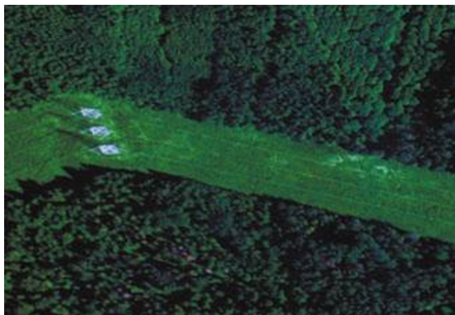
Рис. 1.9. Гиперспектральное RGB-изображение просеки в лесу с линией электропередачи, полученное с борта самолета
