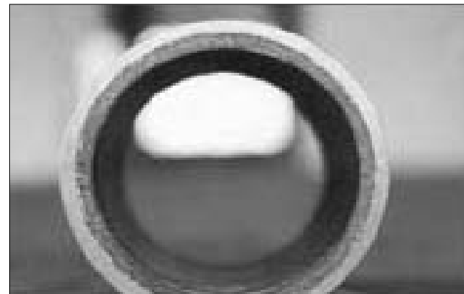
Рис. 2. Разрез стальной композиционной трубы с керамической облицовкой.
