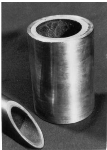
Рис. 7. Градиентная труба, изготовленная в ИСМАН по технологии центробежного СВС-литья.
