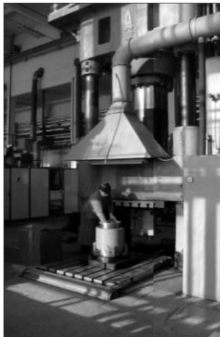
Рис. 6. СВС- производство больших твердосплавных деталей
