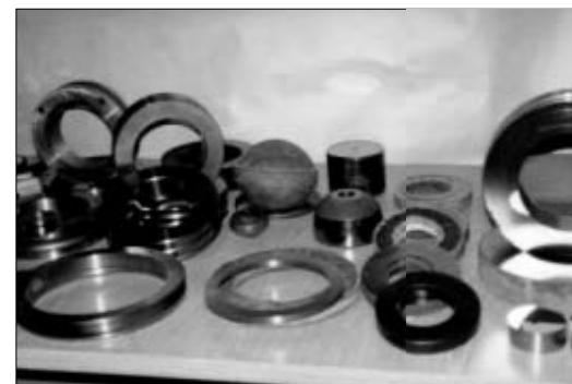
Детали из твердых сплавов, полученные методом СВС
