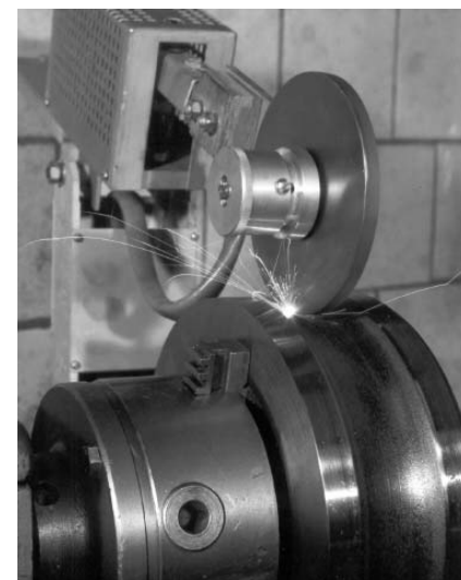
Рис. 6. Механизированный вариант упрочнения поверхности прокатного вала методом ТРЭУ на участке НУЦ СВС МИСиС-ИСМАН
