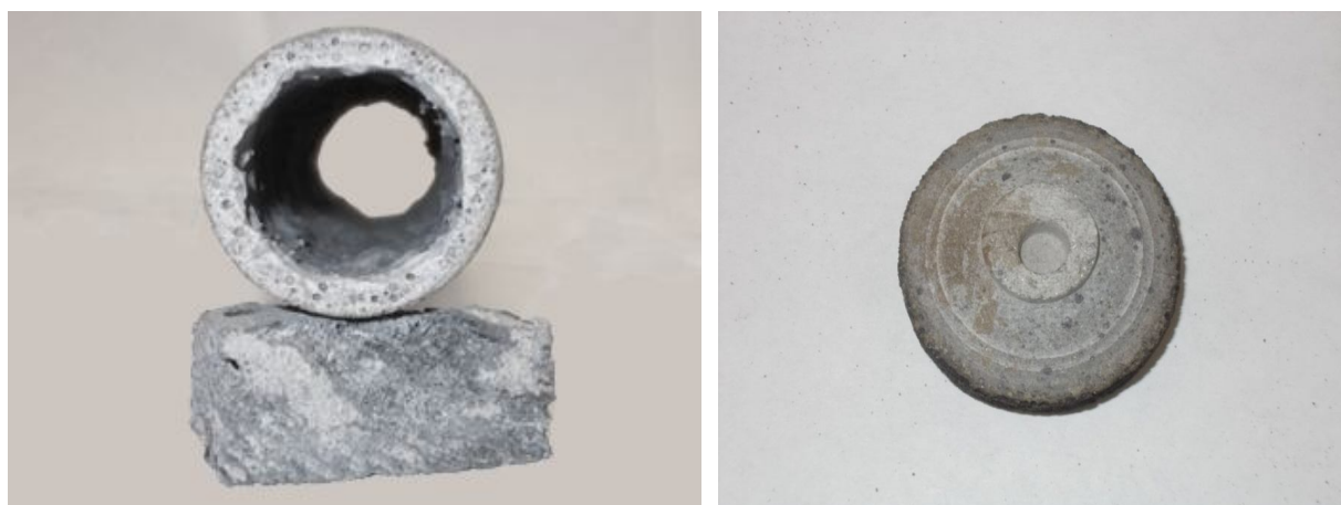
Рис. 7. Изделия из плавнелитого материала на основе фторфлогопита: а) без обработки; б) слиток, обработанный на токарном станке.
