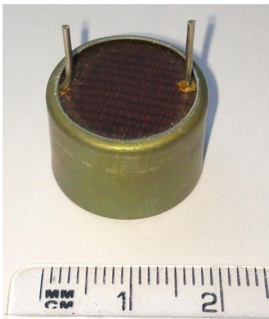
Рис. 2. Фотография макета пиротехнического источника тока, состоящего из трех ВГЭ.
