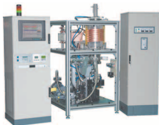
Автоматизированная установка для выращивания монокристаллов
