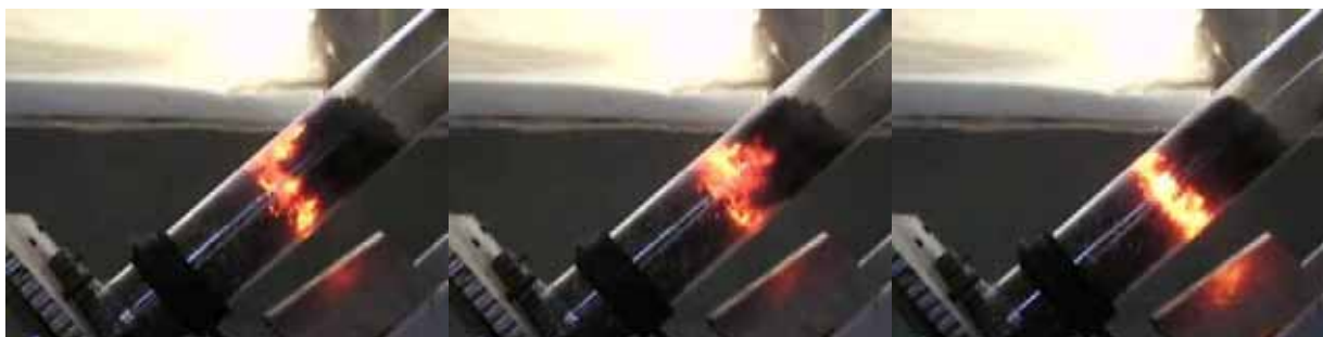
Рис. 5 Подавление прогара: а) Начальное состояние прогара в момент возобновления вращения; б) через 1 сек; в) через 6 сек (1 оборот).
