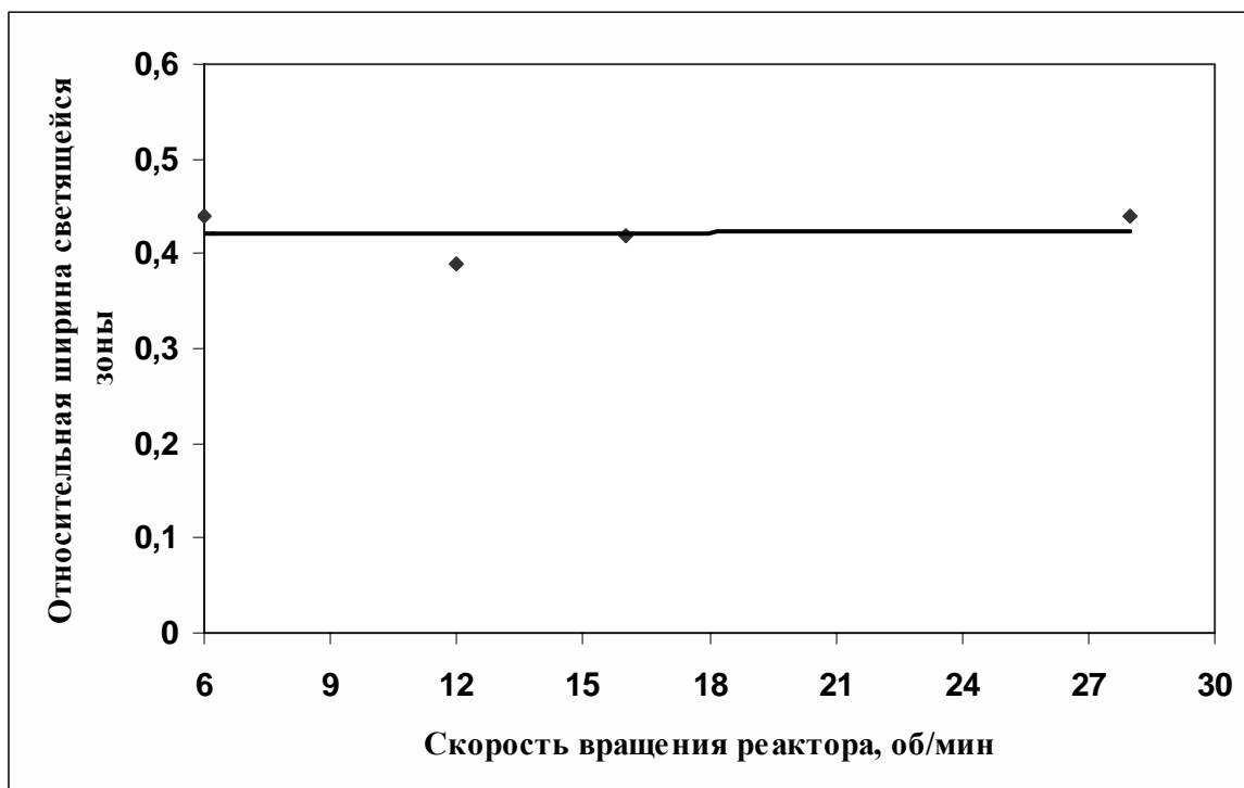
Рис. 7 Влияние скорости вращения реактора на ширину светящейся зоны.
