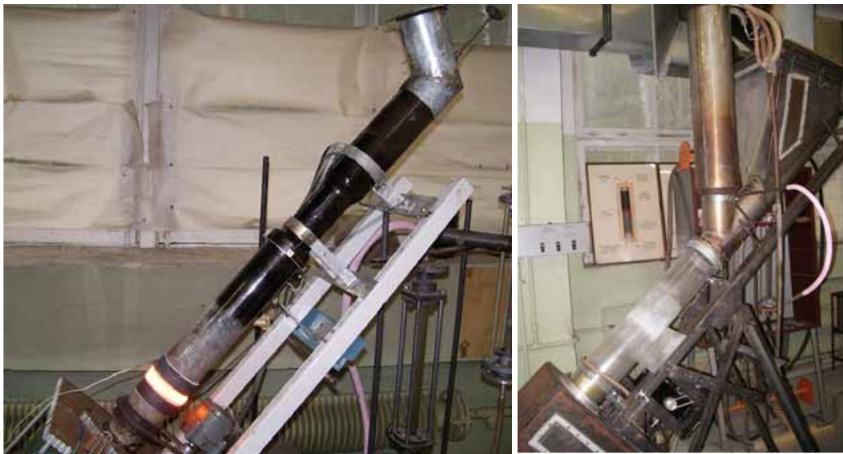
Рис. 1 Экспериментальные установки с диаметром реактора 66 мм (слева) и 160 мм (справа).
