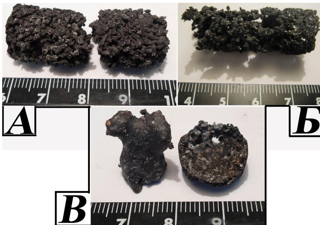
Рисунок 4. Внешний вид образцов из гранулированной смеси после горения: а – без потока газа, б – в потоке аргона, в – в потоке азота.
