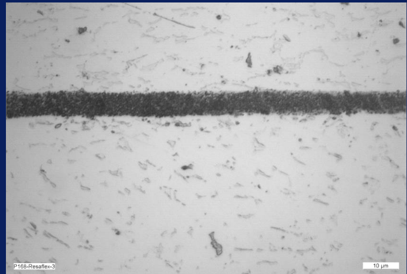
Ti6,4 cladding using D = 7.2 \text{ km/s}
