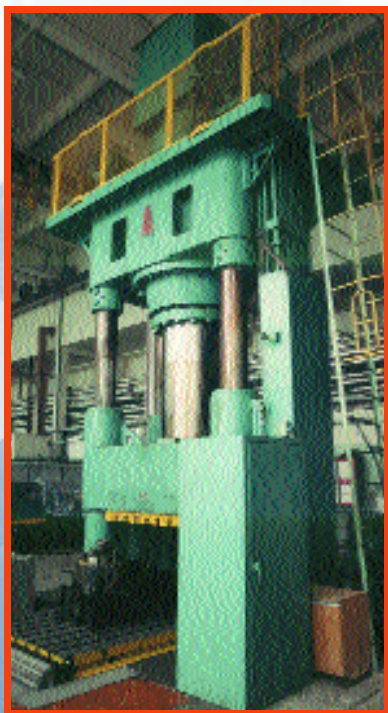
Пресс для получения крупногабаритных изделий методом СВС-компактирования
