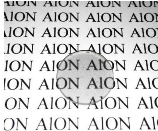
Фотография оптически прозрачного образца, спеченного из порошка AlON
