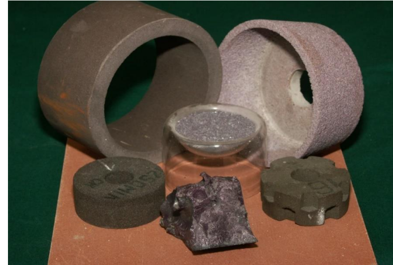
Абразивный инструмент из I2O3/Cr2O3 для обработки твердых сталей
