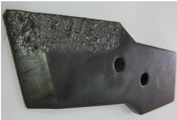
Z-образное долото плуга Kuhn multi master с защитным твердосплавным покрытием
