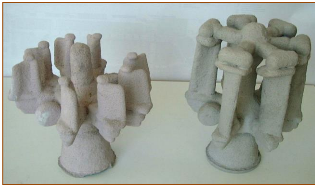
Литейные формы и формообразующие стержни их оксидных материалов (Al2O3/Cr2O3) и SiO2/Cr2O3 для изготовления лопаток ГТД и ГТУ
