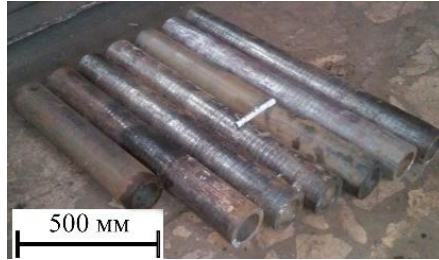
Двухслойные трубные заготовки сталь «37Г2Ф+08Х18Н10Т» (длина до 2,5 м). Трубы применяются для изготовления насосно-компрессорного оборудования, применяющихся в нефтедобывающей промышленности
