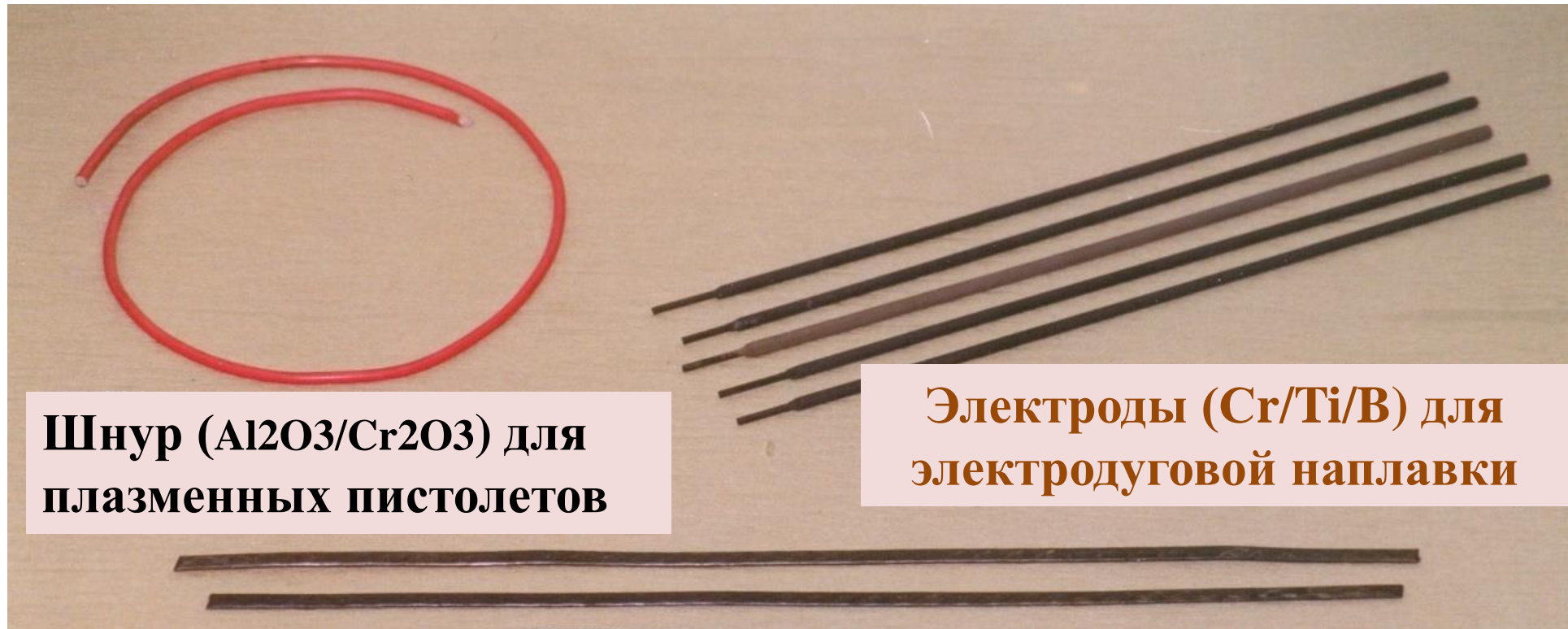
Наплавочные порошковые ленты ( Cr-C-Ni ) для автоматической электро-дуговой наплавки
