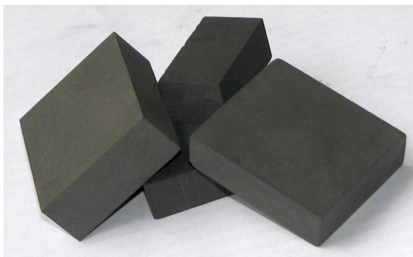
Рис. 2. Фотография образцов композита TiC+0,5C.
