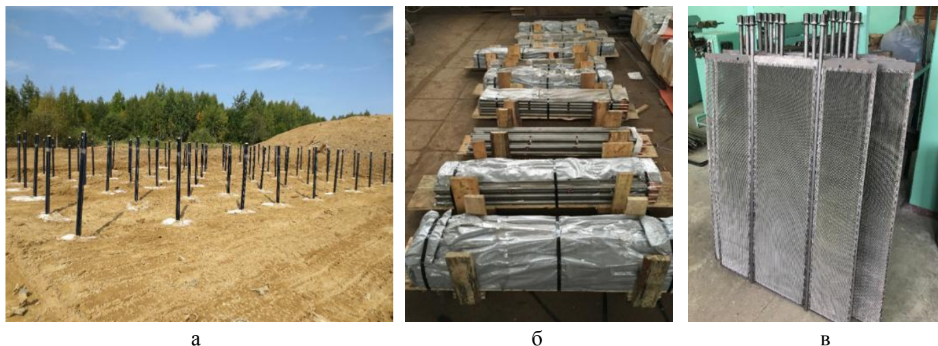
Рисунок 12 – Результаты освоения промышленной технологии получения сваркой взрывом медно-титановых токоподводов: а – собранные пакеты на взрывной площадке; б – партия готовых стержней; в – собранные анодные ячейки
