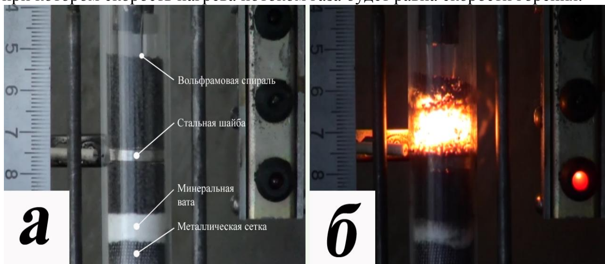
Рисунок 9. Фотографии исходной и горящей гранулированной смеси \text{Ti}+0.5\text{C} , разделенной на две части специальным узлом (см. рисунок 8) в потоке аргона: а - исходная смесь перед синтезом, б - в процессе горения.
