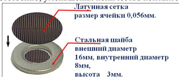
Рисунок 8. Схема узла разделяющего на две части гранулированную засыпку.
