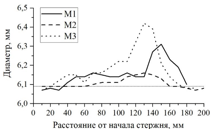
Рисунок 13 – Изменение диаметра стержней по длине, полученных по режимам M1–M3
