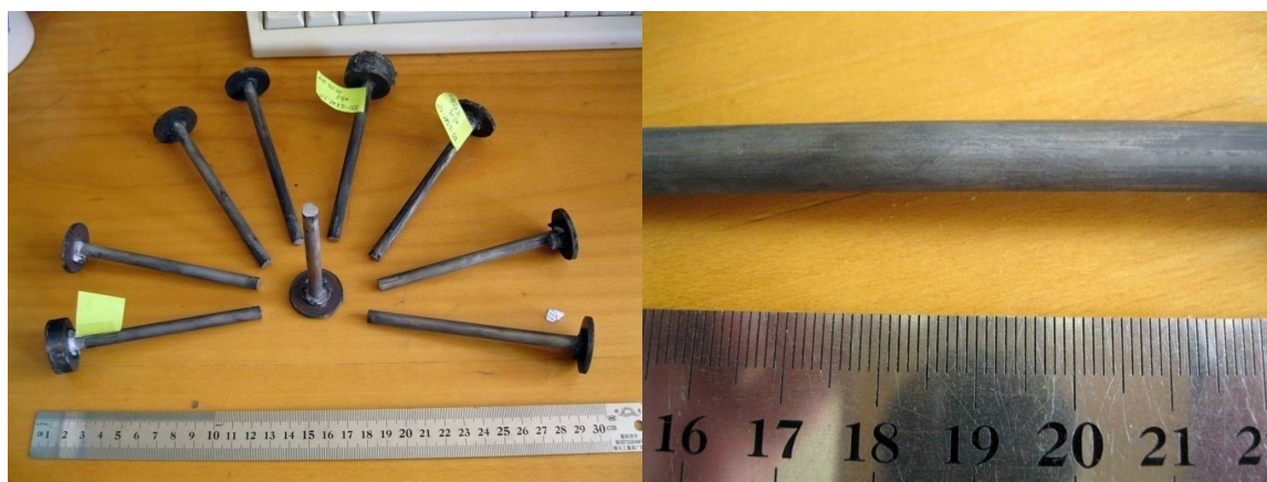
Рисунок 8 – Общий вид экструдированных СВС-электродов состава 3Ti-2,3Al-2C
