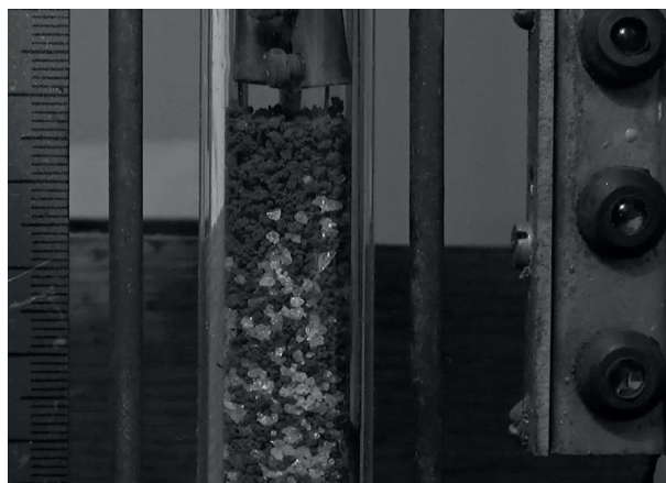
Рис. 5.2. Фотография кварцевой трубки с гранулированной шихтой Ti + C , разбавленной на 70% крупными частицами Al_2O_3 , в установке перед сжиганием (сверху 10 мм засыпка гранул Ti + C без разбавления для обеспечения равномерного поджига).
