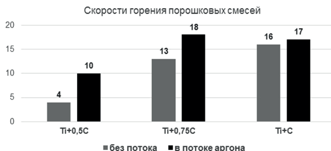
Рис. 4.1. Скорость горения порошковых смесей Ti + xC (мм/с) без потока и в потоке аргона, \Delta P = 1 атм.
