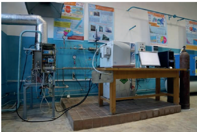
Рис. 3. Общий вид демонстрационной установки матричной конверсии природного газа в синтез-газ атмосферным воздухом. Расход газа до 10 \text{ м}^3/\text{ч} [24].
