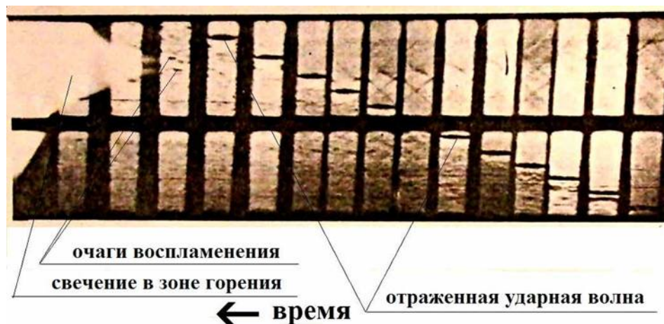
Рис.1.6. Шлирен-фотография процесса возникновения и развития горения за отраженной от торца трубы ударной волной ( \text{H}_2 + \text{O}_2 , 50 Торр, 300К).
