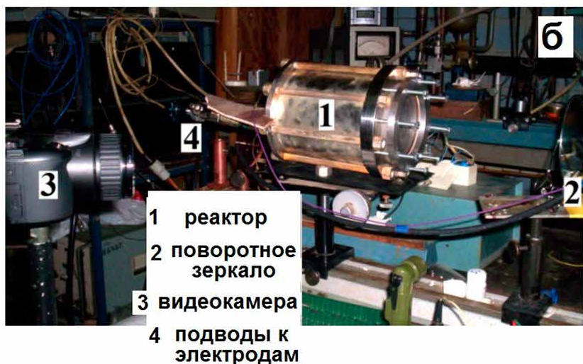
Рис. 3.1. Установки для изучения распространения сферических пламен при пониженном давлении (а) (реактор III) и атмосферном давлении (б) (реактор IV) .
