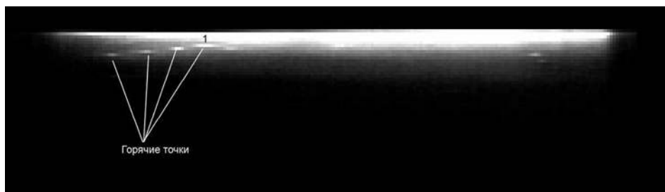
Рис.1.14. RGB гиперспектрального изображения горения смеси 40% H_2 – воздух, инициированного платиновой проволокой, полученный при использовании модифицированного гиперспектрометра ВИД-ИКЗ, T_0 = 320^0\text{ C} , P_0 = 1 атм, спектральный интервал 550 – 650 нм.
