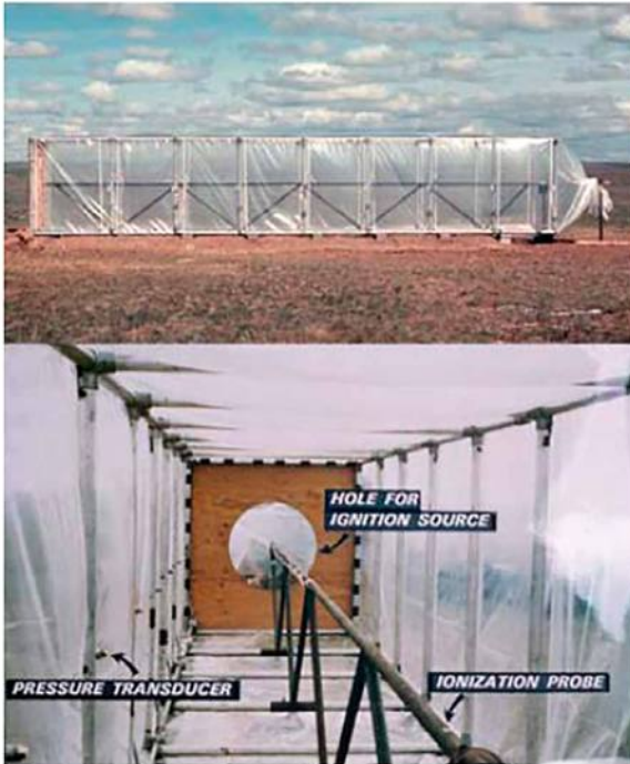
Рис.1.4. Экспериментальная установка для изучения прямого инициирования детонации тетранитропентаэритритом (ТЭН). Длина 10 м, ширина и высота 1.83 м. Стенки - полиэтилен.
