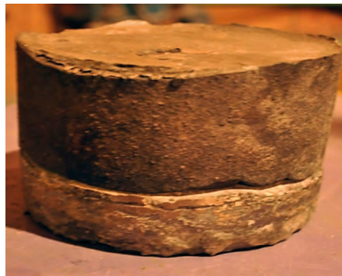
Рис. 20. Вид литых продуктов горения. Исходная смесь: \text{CrO}_3/\text{TiO}_2/\text{NiO}/\text{Al}/\text{C} . P_0 = 5 МПа, газ — аргон
