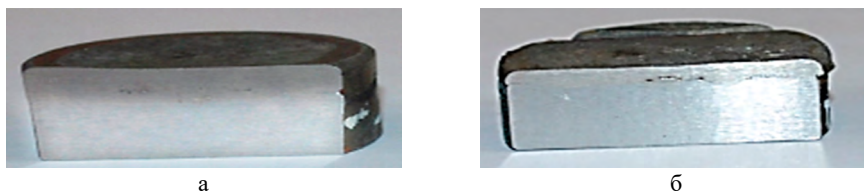
Рис. 58. Наплавленные образцы: (а) — Mo/C/Ni/Al-титан и (б) — Mo/B/Ni/Al-титан. M_0 = 60 г, a/g = 100
