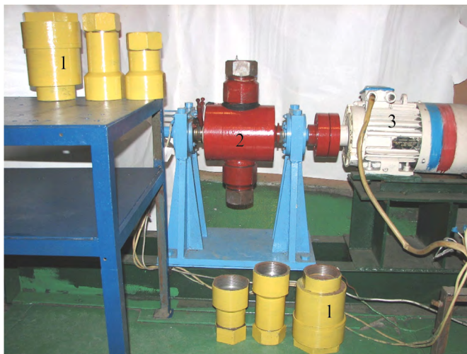
Рис. 1. Внешний вид многоцелевой центробежной СВС-установки: 1 — сменные реакционные камеры, 2 — ротор центробежной установки, 3 — электродвигатель
