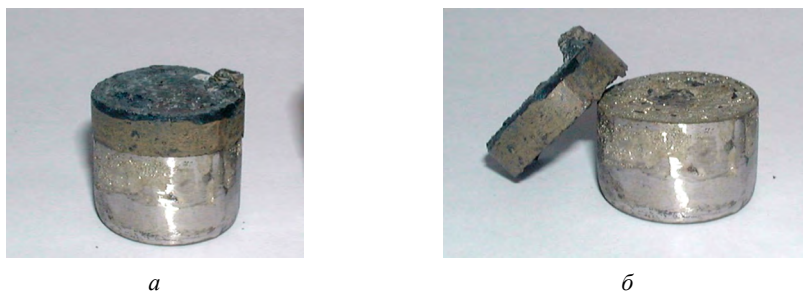
Рис. 22. Внешний вид образца, сгоревшего при воздействии перегрузки 750 g. Система: (\text{Ti} + \text{Al}) + (\text{CaO}_2 + \text{Al}) \rightarrow \text{TiAl} + \text{Al}_2\text{O}_3 - \text{CaO} , а — после извлечения из формы, б — после отделения оксидной фазы
