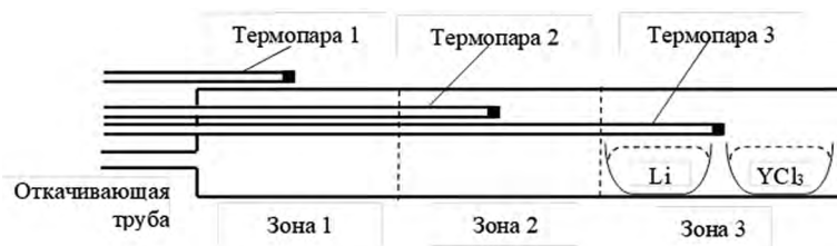
Рис. 4. Горизонтальный аппарат для литиетермического восстановления хлорида иттрия [9]. Диаметр трубы реактора — 7,6 см; общая длина — 56 см; протяженность зон: 1 — 18 см, 2 — 18 см, 3 — 20 см
