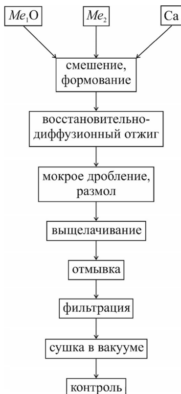
Рис. 12. Технологическая схема RD-процесса
