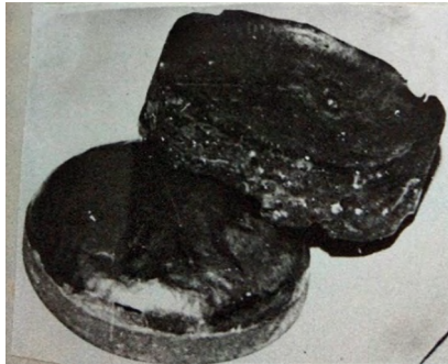
Рис. 51. Вид наплавленного образца по схеме (рис. 50 б). Смесь — \text{CrO}_3/\text{TiO}_2/\text{NiO}/\text{MoO}_3/\text{Al}/\text{C} . Давление аргона 5 МПа, основа — цилиндр из Ст-3 диаметром 40 мм. h_1 = 4 мм, h_2 = 10 мм
