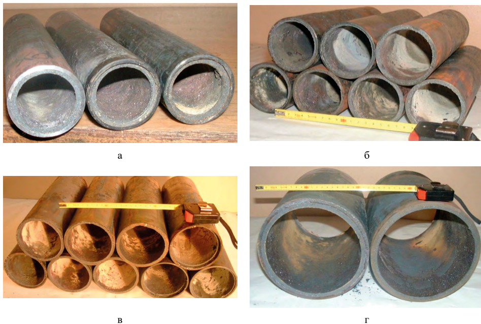
Рис. 40. Внешний вид труб с металлокерамическим покрытием. а — d = 57 мм, L = 300 мм; б — d = 76 мм, L = 300 мм; в — d = 108 мм, L = 300 мм; г — d = 220 мм, L = 300 мм
