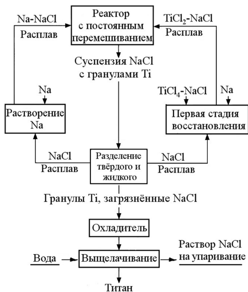
Рис. 1. Принципиальная технологическая схема непрерывного способа получения гранулированного титана [7]
