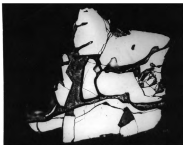
Рис. 21. Макроструктура разлома частицы порошка композиционного материала (увеличение \times 200 ): \text{Cr}_3\text{C}_2 + 30\% \text{NiAl}
