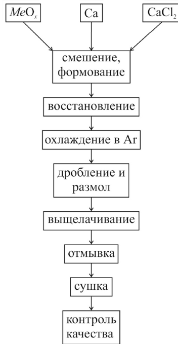
Рис. 11. Схема кальциетермического восстановления оксидов металлов с использованием хлорида кальция
