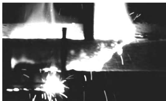
Рис. 11. Вид распространения фронта горения высококалорийной смеси после прохождения преграды, отсекающей конвективный двухфазный поток
