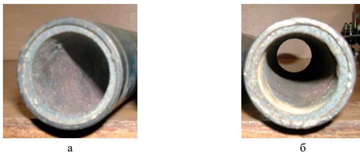
Рис. 33. Внешний вид труб с керамическим покрытием, полученных с использованием окислыны (а) и с использованием Fe_2O_3 химической чистоты (б) ( d = 57 мм, L = 300 мм)
