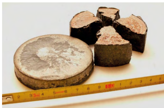
Рис. 24. Продукты горения смеси \text{TiO}_2/\text{Nb}_2\text{O}_5/\text{Al} + 40 масс. % (\text{CaO}_2 + \text{Al}) , металлическая фаза (сплав \text{Ti-Al-Nb} ) и оксидная фаза \text{Al}_2\text{O}_3\text{-CaO}
