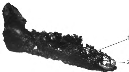
Рис. 12. Вид конечных продуктов горения после остановки фронта горения для смеси с низким тепловым эффектом. 1 — оксидная фаза ( Al_2O_3 ), 2 — металлический слиток
