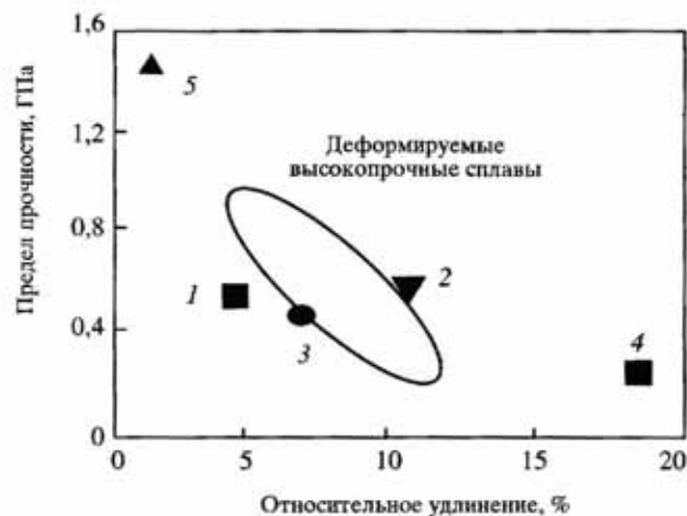
Рис. 7.3. Соотношения между прочностью и пластичностью для различных алюминиевых сплавов
