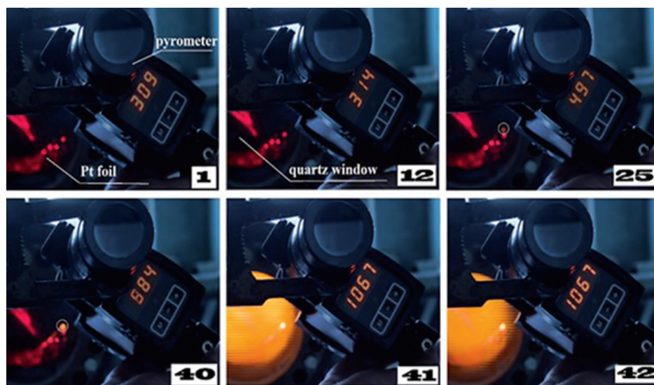
Рис. 3.2. Регистрация инициирования воспламенения 40% H_2 + воздух фольгой Pt двухлучевым цветным пирометром, указывающим значения температуры в °С. Центр зажигания на фольге показан белым кругом на кадрах 25, 40. P_0 = 1 атм. T_0 = 305 °С
