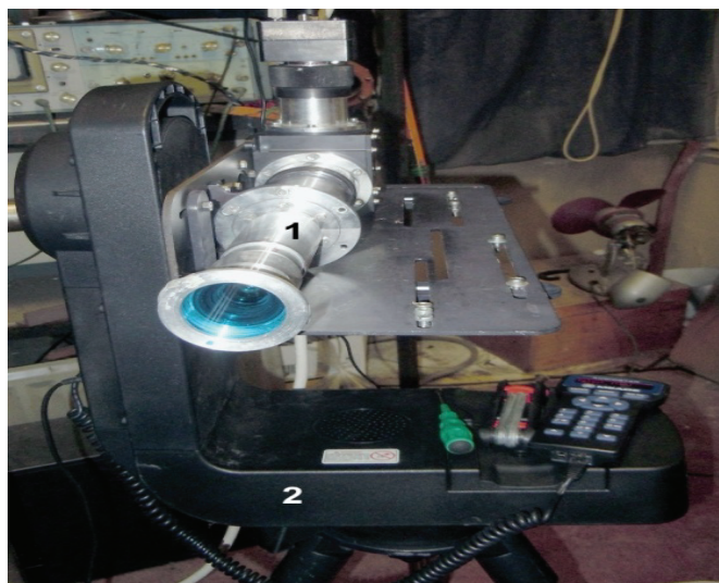
Рис. 3. Расположение гиперспектрометра ИК-ВИДЗ (1) на поворотном устройстве (2).
