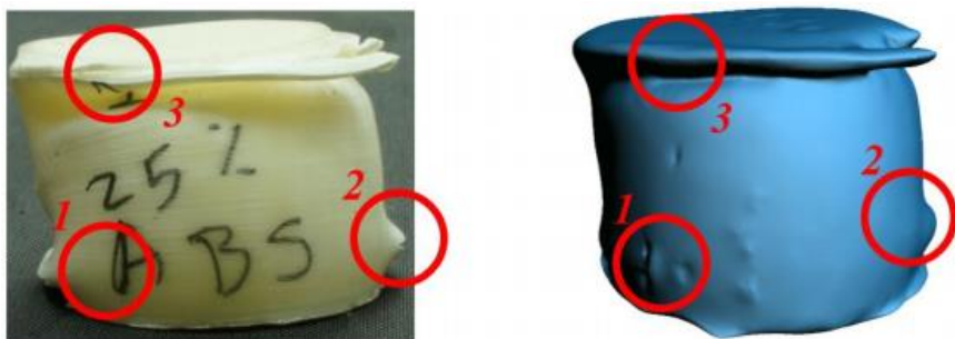
а) натуральный образец после деформирования б) 3D-модель, полученная на основе сканирования
