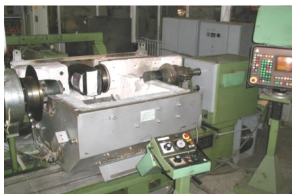
Рис. 1. Общий вид стана СРЖД-800 (а) и стана РНС-600 (б) для раскатки деталей газотурбинных двигателей.
