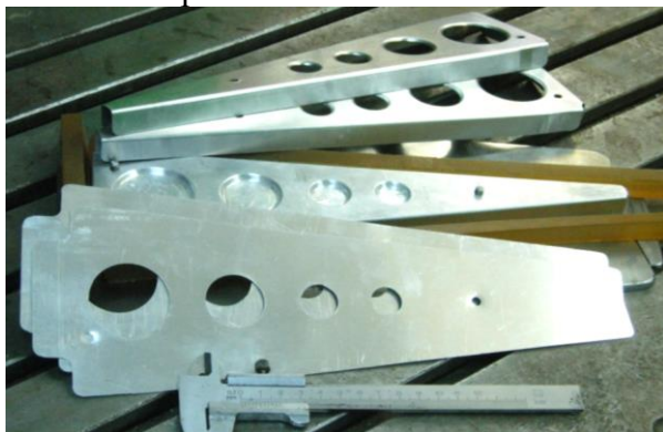
Рис. 1 – Технологическое оснащение, заготовки деталей и отштампованные детали
