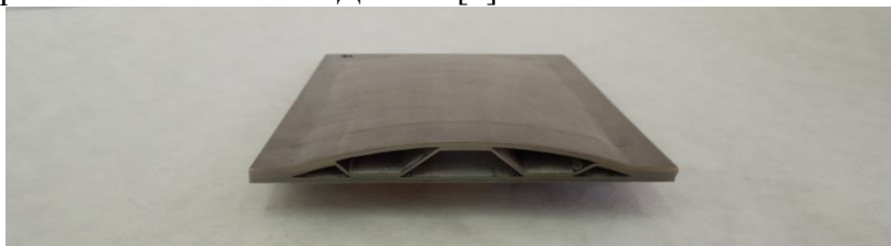
Рис.1. Модель полой лопатки, полученная при 800 °С.
