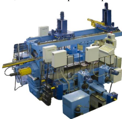
Рис. 1. Общий вид стана СРЖД-800 (а) и стана РНС-600 (б) для раскатки деталей газотурбинных двигателей.
