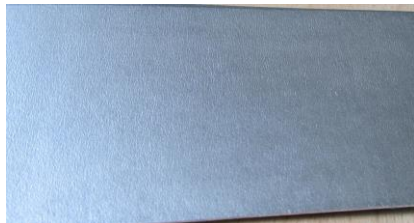
Рис. 1 – Поверхность алюминиевого листа после прокатки с обжатием 10% совместно с листом офисной бумаги
