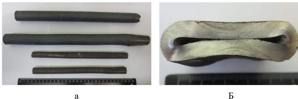
Рис. 3. Полученные биметаллические образцы после горячей деформации: а – внешний вид образцов; б – образец после испытания на сплющивание
