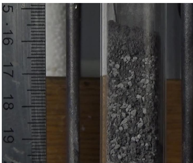
Рис. 1. Внешний вид смеси, состоящей из гранул Ti+C (более темные) и Ni+Al (более светлые) с поджигающей подсыпкой Ti+C сверху
