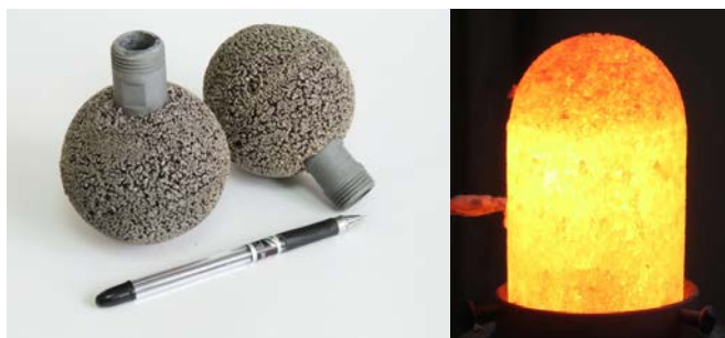
Рис. 1. Пористые Ni–Al горелки, получаемые методом СВС.
