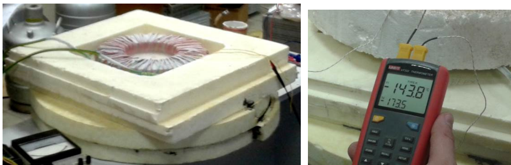
Рис. 2. Испытания сердечников магнитной системы бесщеточного возбuditеля при температуре азота
