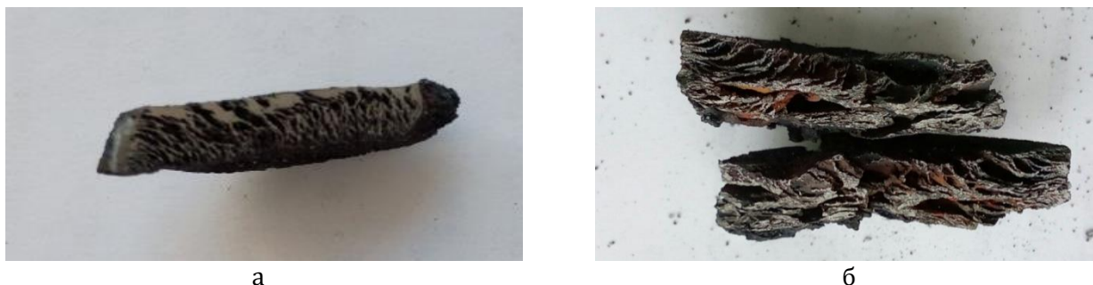
Рис. 2 – Скол образца Ti_3SiC_2 после пропитки железом с добавлением: а) 4% углерода, б) 5% кремния.
