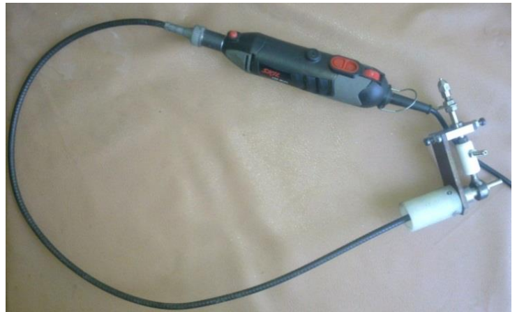
Рис. 6 – Электромеханические вибраторы для формирования электроискровых покрытий: (а) – с внутренним и (б) – внешним расположением электродвигателей
