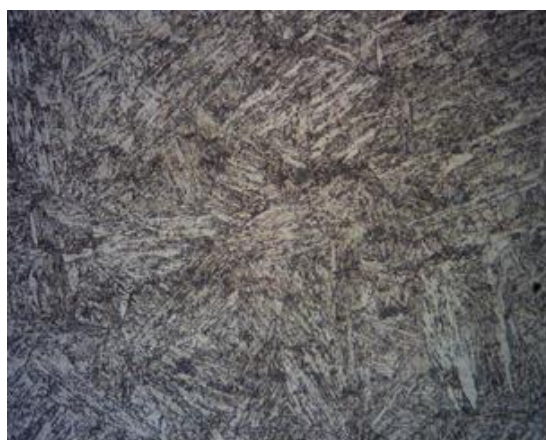
Рис. 2 – Микроструктура образца (сталь 12X13-Ш): (а) – до, (б) – после нанесения стеллитового покрытия \times 500 (Травитель 4-х% спиртовой раствор \text{HNO}_3 )
