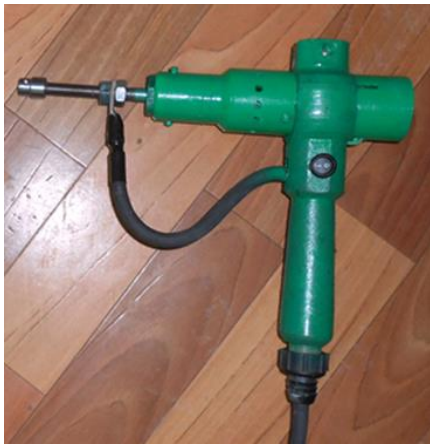
Рис. 6 – Электромеханические вибраторы для формирования электроискровых покрытий: (а) – с внутренним и (б) – внешним расположением электродвигателей
