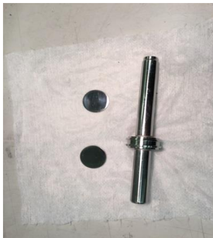
Рис. 4. Макет штока и образцы-свидетели с защитным покрытием, имеющим в своем составе детонационные нанодIAMAZHы. Напыление произведено в АО Петровский НЦ «ФУГАС».
