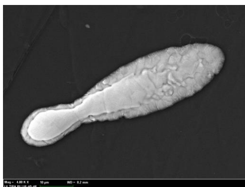
Рис. 1. Растекание частицы Ti по поверхности стеклографита (сканирующая электронная микроскопия) с одновременным образованием зерен продукта.
