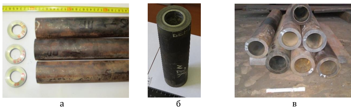
Рисунок 3 – Полученные сваркой взрывом биметаллические трубные заготовки
