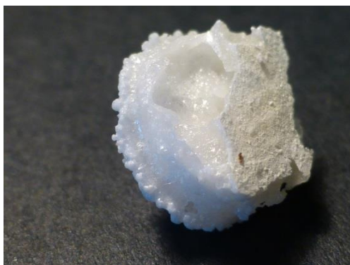
Рис. 2. Внешний вид образца, полученного спеканием из порошка, синтезированного методом сжигания азотсодержащего алюмогеля.
