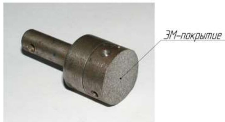
Рис. 2. Образец (в сборе) для определения величины адгезионной прочности ЭМ-покрытия.
