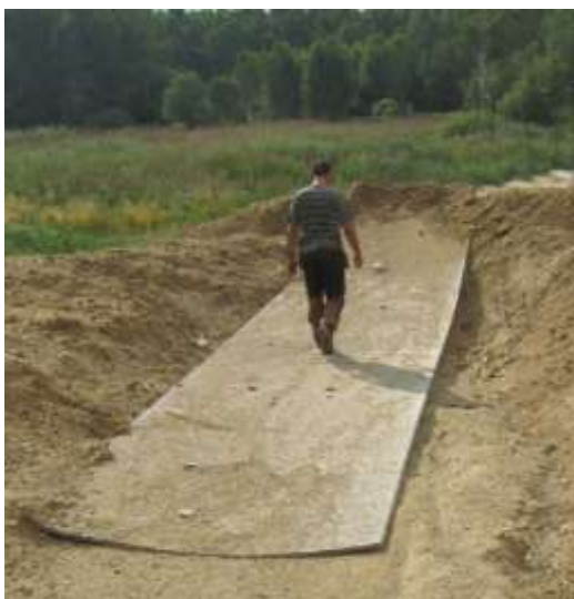
Рис. 4. Листы биметалла: сталь+коррозионностойкая сталь, размером 2х13 м, после сварки взрывом (а) и сталь+титан, размером 2х2 м после правки.
