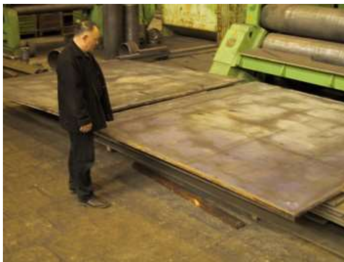
Рис. 4. Листы биметалла: сталь+коррозионностойкая сталь, размером 2х13 м, после сварки взрывом (а) и сталь+титан, размером 2х2 м после правки.
