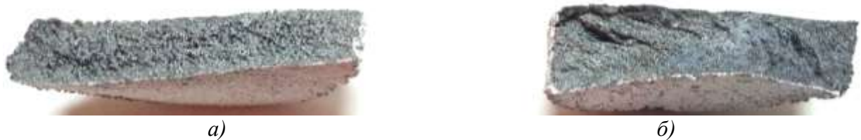
Рис. 2. Фотографии поверхности излома образцов без замены (а) и с заменой 20 % углерода на порошок ( \text{AlN}+5\%\text{Na}_3\text{AlF}_6 ) (б).
