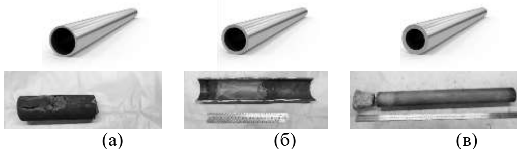
Рис. 3. Экспериментальные образцы кристаллизаторов с различными толщинами стенок. (а)-3мм, (б)-5мм, (в)-6мм.
